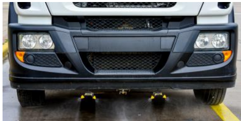
Figura 2-6 Sistema de Riego
