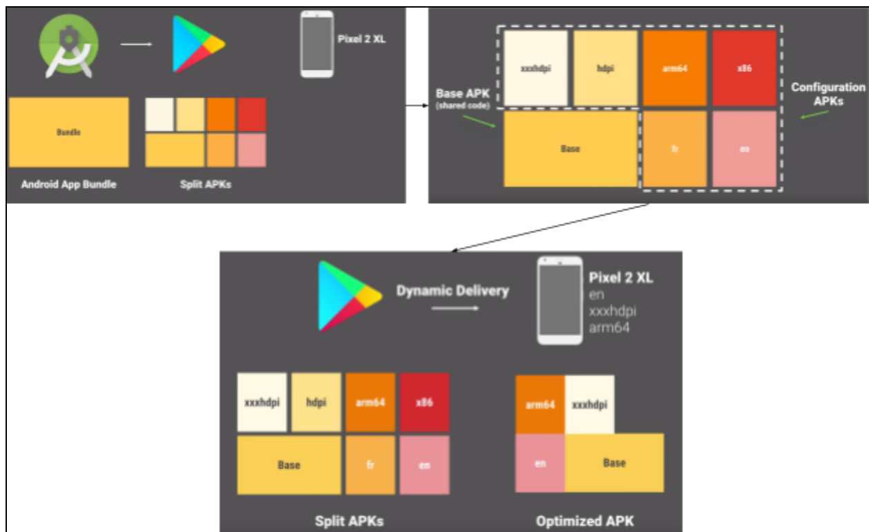
Figura 4.0: Lógica de instalación de componentes de Android App Bundle. Fuente: Google.
