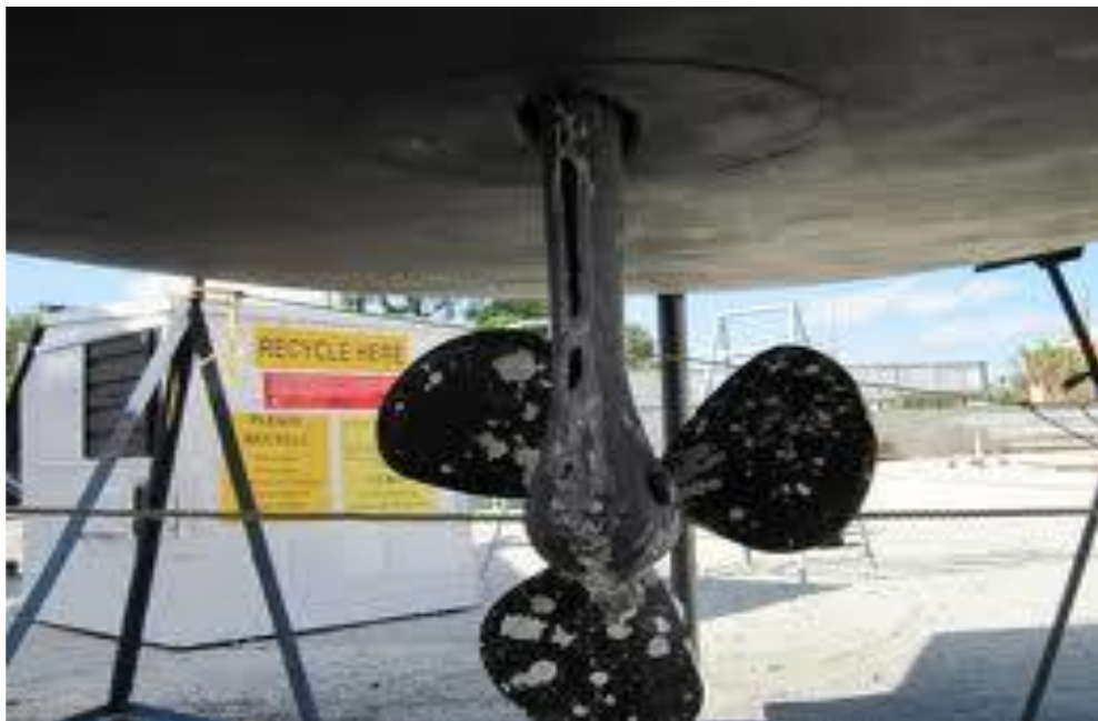
Figura 3: Signos típicos de corrosión en unidades de propulsión y propulsores marinos inferiores, visto fuera de flota. (Kulkarni, 2011)
