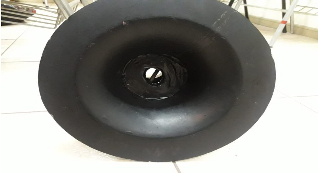
Figura 2-13. Instalación del reductor en el tubo annubar . Fuente, fotografía tomada en el taller de mecánica automotriz.
