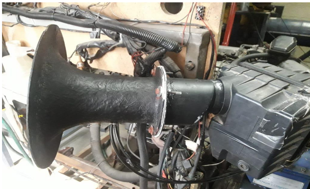
Figura 2-4. instalación del tubo annubar en el porta filtro. Fuente, fotografía tomada en el Laboratorio de Máquinas.
