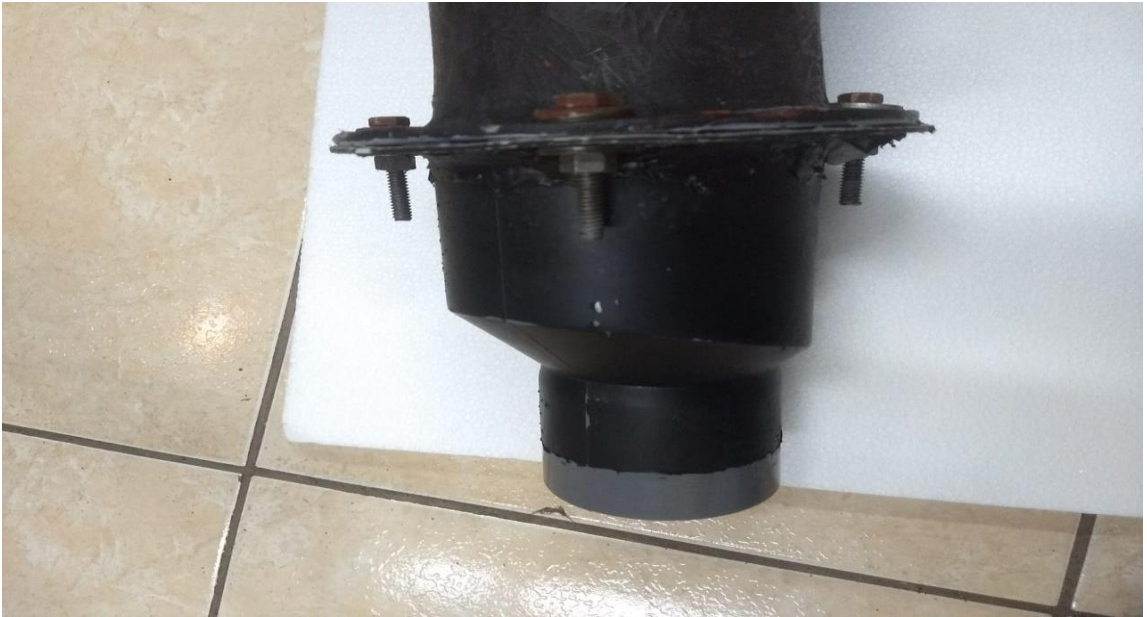
Figura 2-2. Adaptación de acople reductor. Fuente, fotografía tomada en el Laboratorio de Máquinas.
