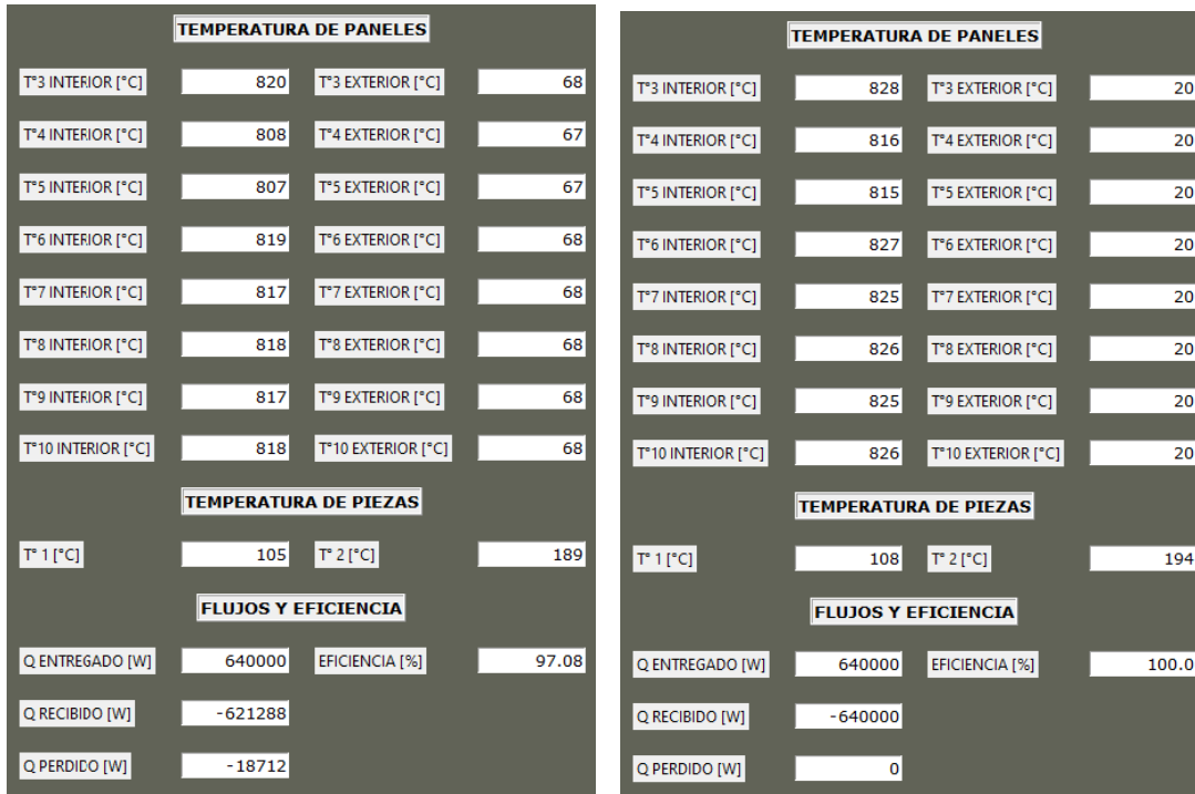
(a) Simulación con pérdidas de calor.
