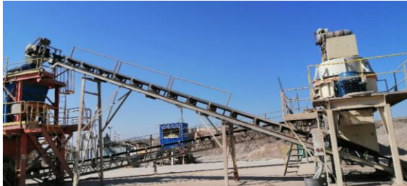
Figura 1-13: Cinta transportadora que alimenta el harnero
