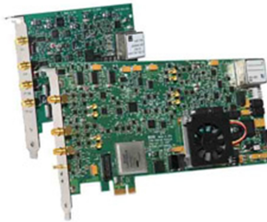
Figura 5-2 – Tarjeta Brilliant Instruments BI220 para analizador de intervalos de tiempo.
