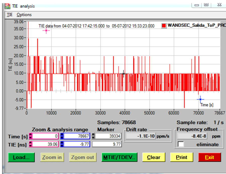
Figura 6-1 Gráfica obtenida de la medición TIE para interfaz PRC
