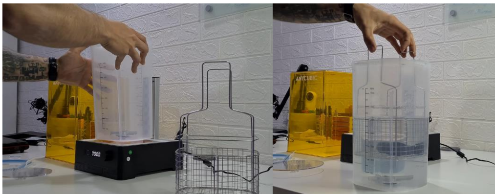
Figura 25 Instalación de vaso precipitado y canastillo (A3DPrints, 2021)
