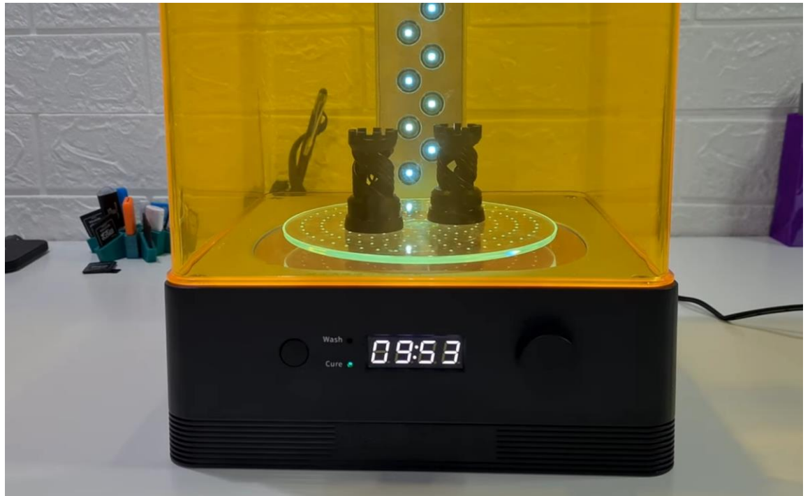
Figura 27 Curado de impresión de resina (A3DPrints, 2021)
