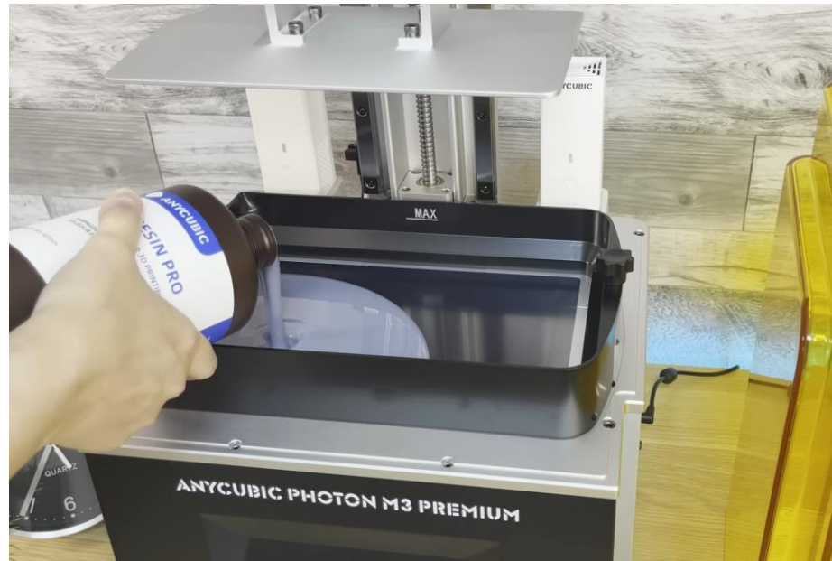
Figura 22 Vertido de resina en Anycubic M3 Photon Premium (Art3DGaliza, 2023)
