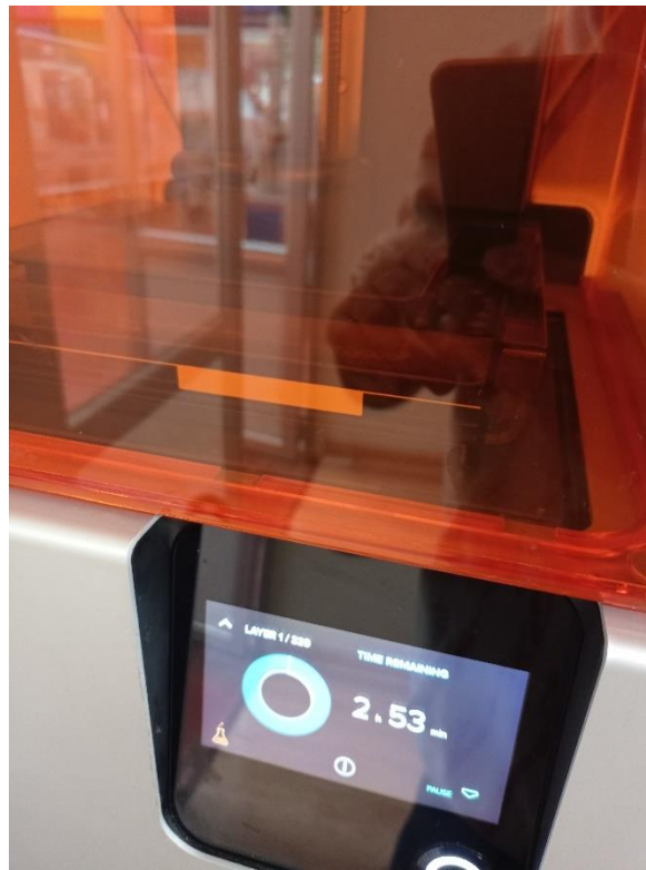
Figura 28 Primera prueba efectuada, duración 2 horas y 54 minutos, FormLabs Form 2. Fuente (Registro propio de trabajo)
