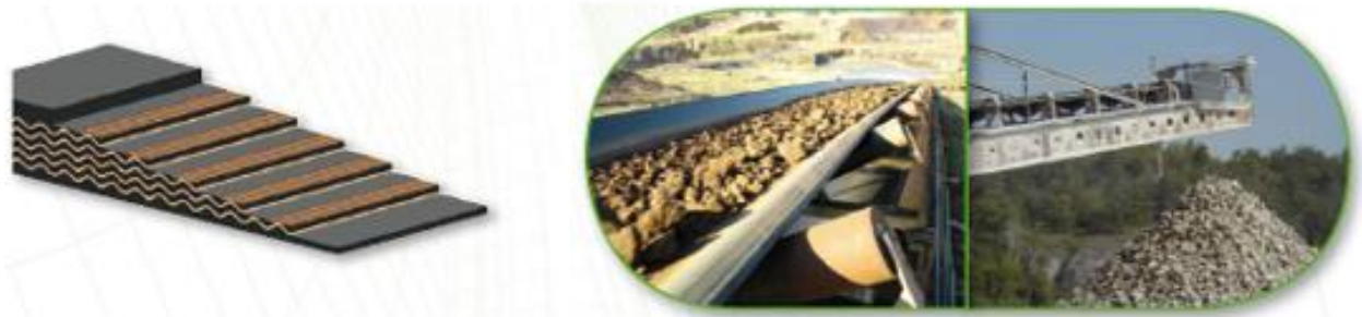
Figura 9. Cubiertas de una correa transportadora.
