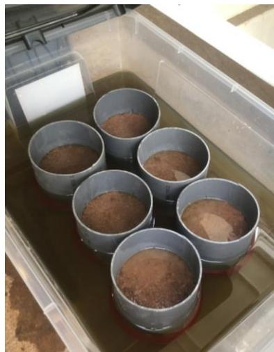
**Figura 96. Moldes con muestra compactada en proceso de saturación con solución ácida.**
