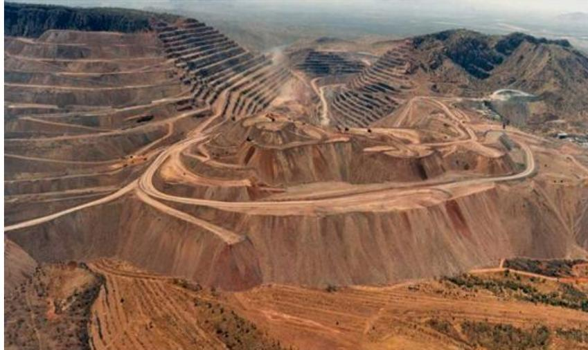
*Figura 54. Vista de un botadero de roca estéril en el noroeste de Australia(G. McPhail 2017)*
