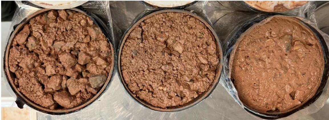
**Figura 97. Probetas saturadas en ácido luego de la extracción del papel filtro**
