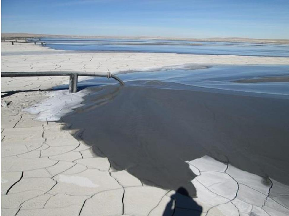
*Figura 33. Relaves de alto espesamiento (Minería chilena w3.mch.cl)*
