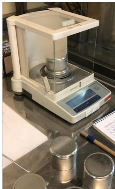
**Figura 93. Medición de contenedores metálicos para el papel filtro en balanza digital de precisión.**
