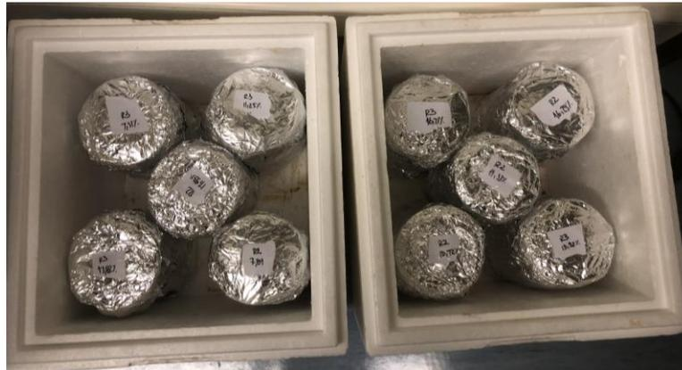
**Figura 92. Probetas terminadas listas para el equilibrio térmico de 7-14 días.**
