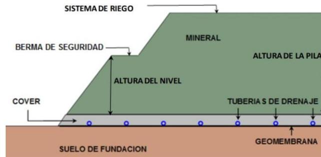
**Figura 63. Esquema del sistema de filtración en la pila (López E. 2012)**
