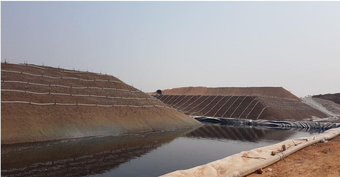
**Figura 61. Irrigadores en pilas de lixiviación. (NETAFIM)**
