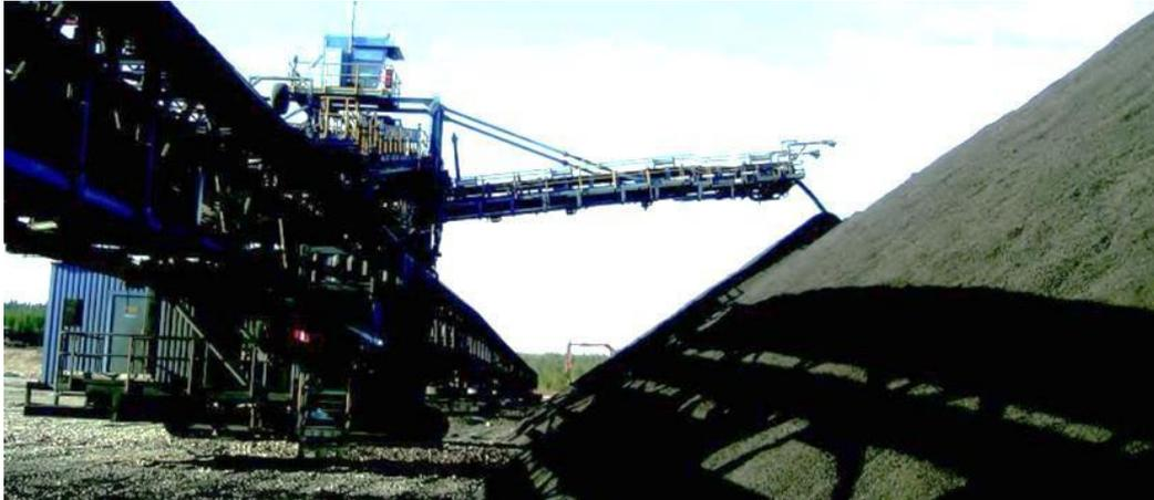
*Figura 56. Apilador descargando ripio en el botadero (Carolina Vergara SRK 2019)*
