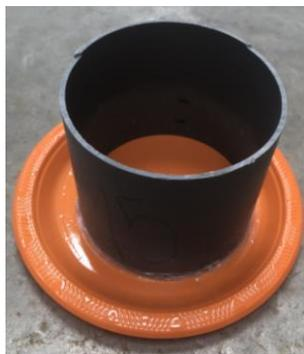
**Figura 84. Molde de PVC para muestras de ripio.**
