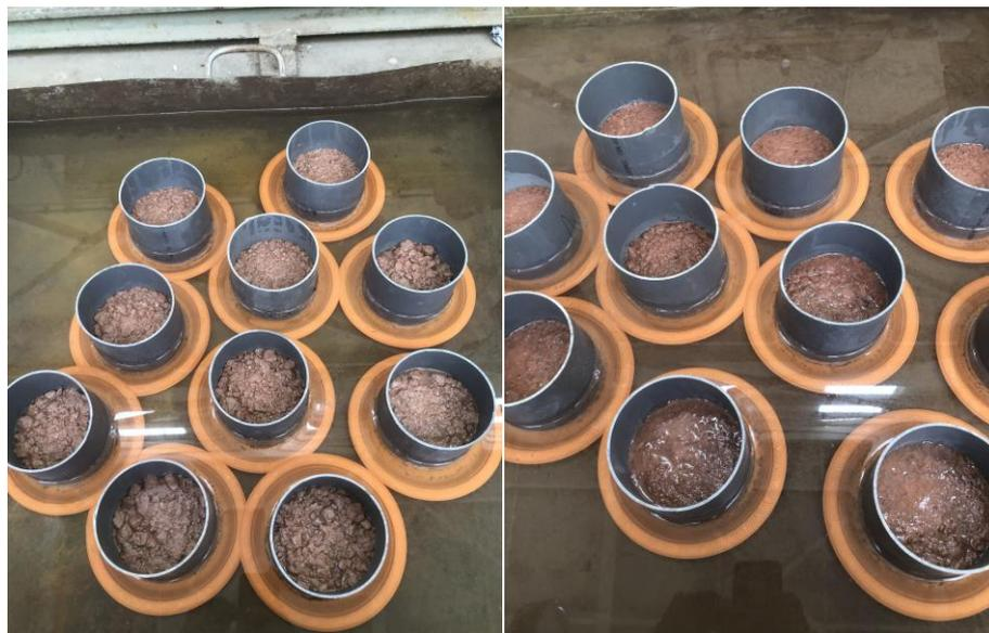
**Figura 86. Moldes con muestras en proceso de saturación. (Izq.) L2 y (Der.) L1**
