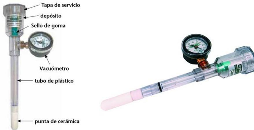
**Figura 71. Tensiómetro (Fotografías y gráficas de QAMPO)**
