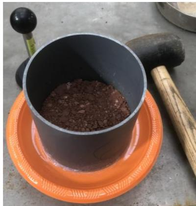
**Figura 85. Compactación por capas para muestra en molde de PVC.**
