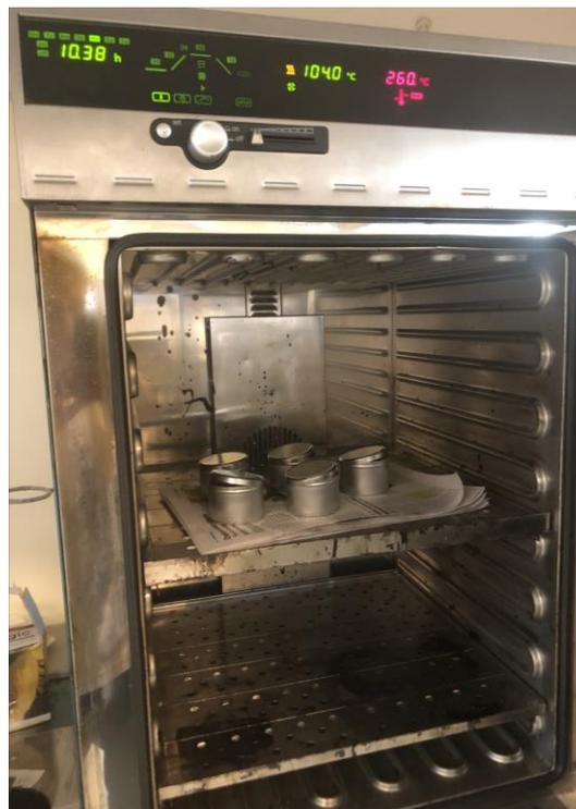
**Figura 94. Horno con contenedores metálicos secando el papel filtro húmedo.**
