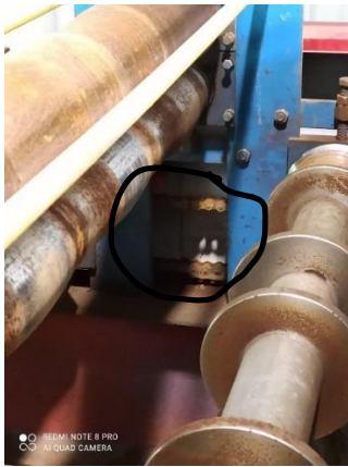
Figuras 16-. CADENA SUCIA Y FALTA DE ENGRASE.
