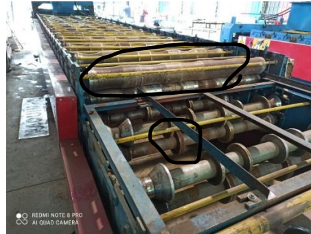
Figuras 15-. RODONES EN MAL ESTADO.
