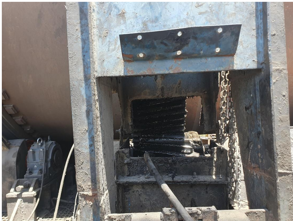
Figura 11.2.5: Piñón-corona, destaca manguera utilizada para lubricación manual. Fuente: (Elaboración propia).
