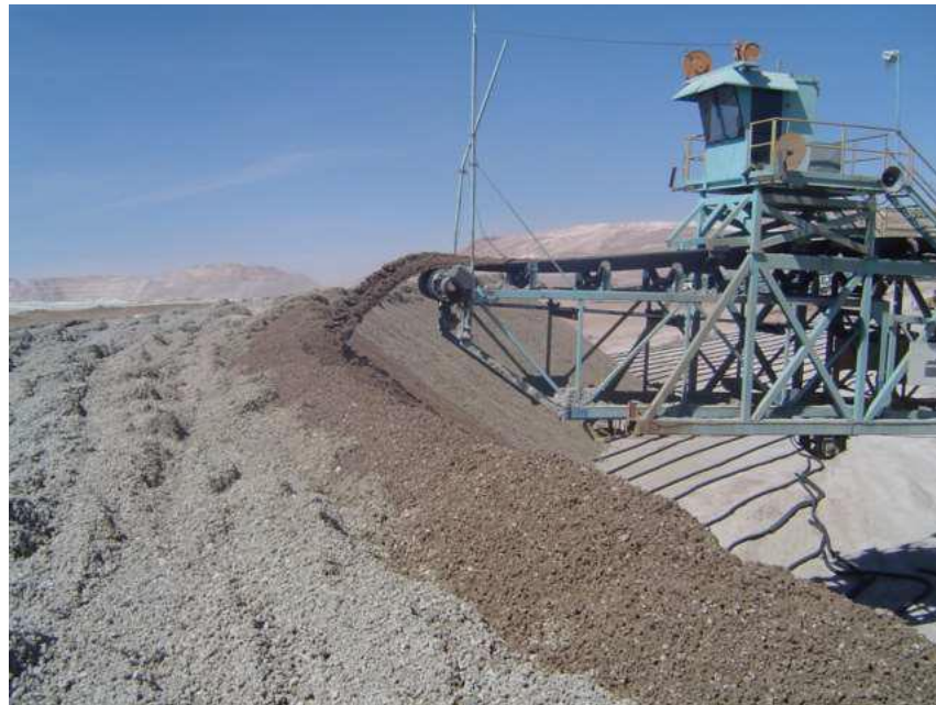
Figura 9.3.1: Formación de Pila de Lixiviación. Fuente: (Aracena, s.f., p. 82)
