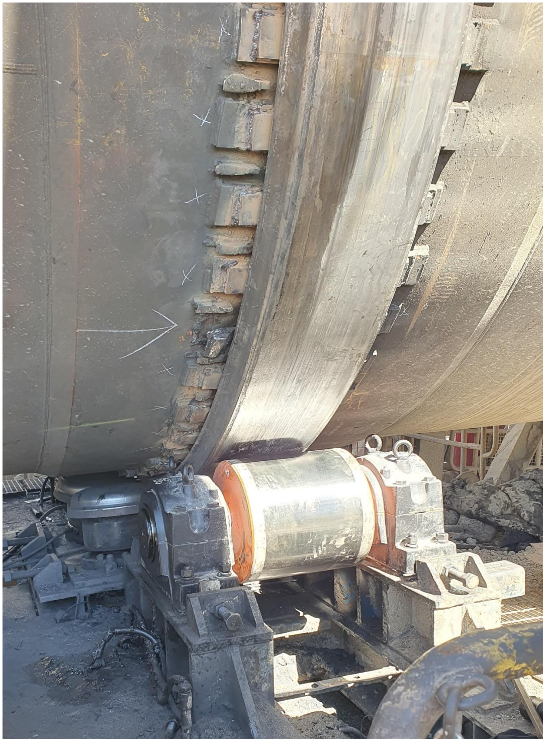
Figura 10.1.5: Rodillo Radial. Fuente: (Elaboración propia).
