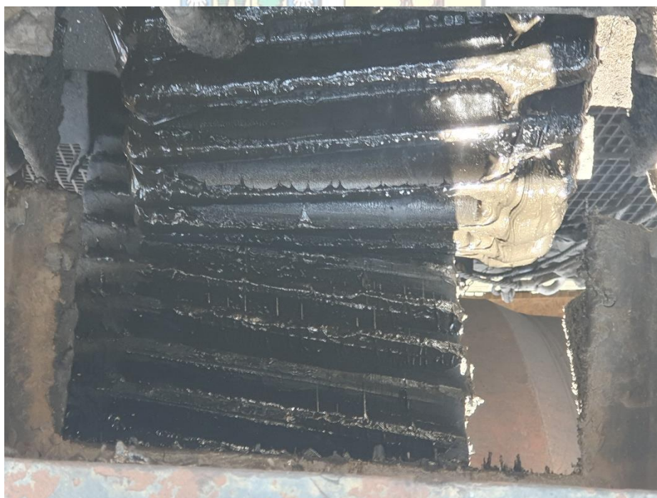
Figura 11.2.6: Piñón-corona, destaca lubricación no homogénea. Fuente: (Elaboración propia).
