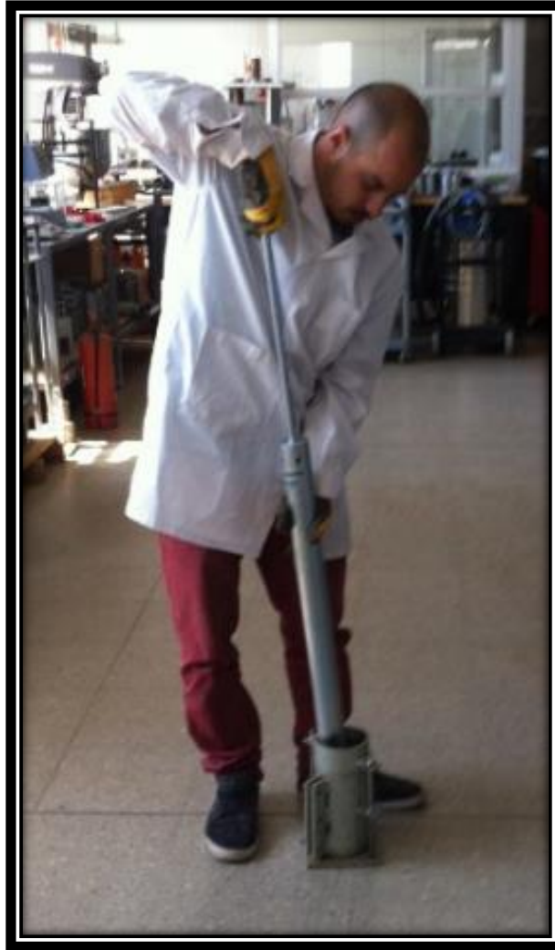
Figura 3-35: COMPACTACIÓN PROBETA TRIAXIAL, (Fuente: propia).
