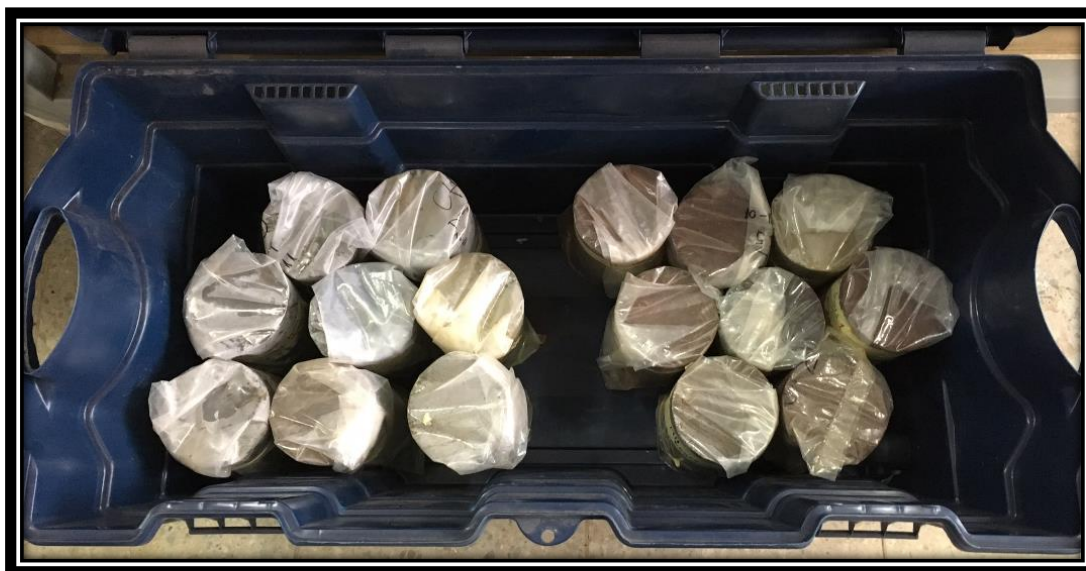
Figura 3-37: PROBETAS TRIAXIALES ALMACENADAS PARA CURADO, (Fuente: propia).
