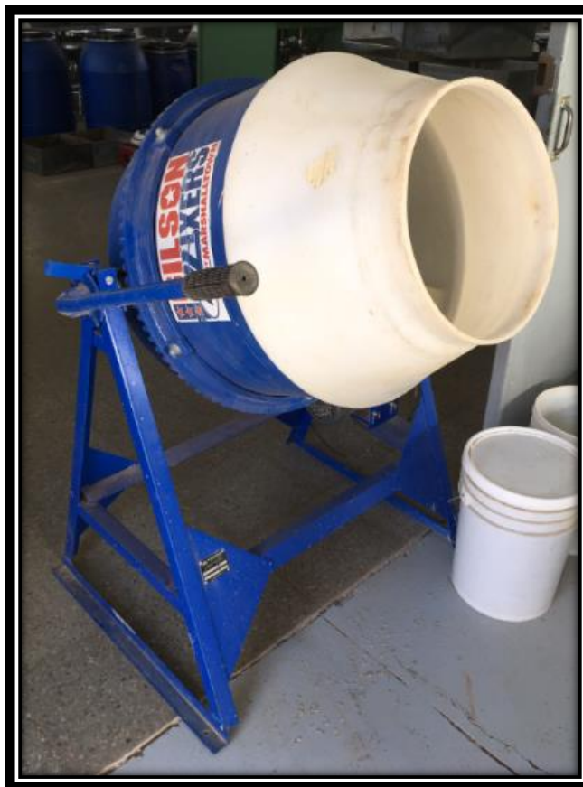
Figura 3-22: BETONERA UTILIZADA EN TRABAJO EXPERIMENTAL, (Fuente: propia).
