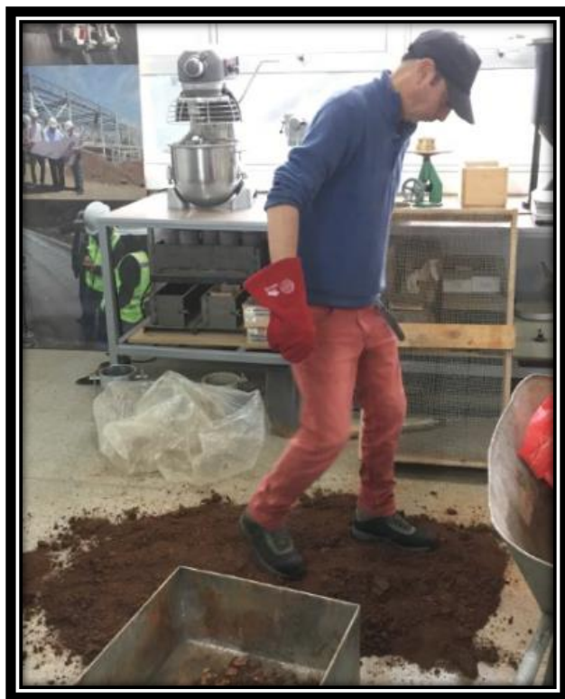
Figura 3-4: HOMOGENEIZACIÓN DEL SUELO, (Fuente: propia).
