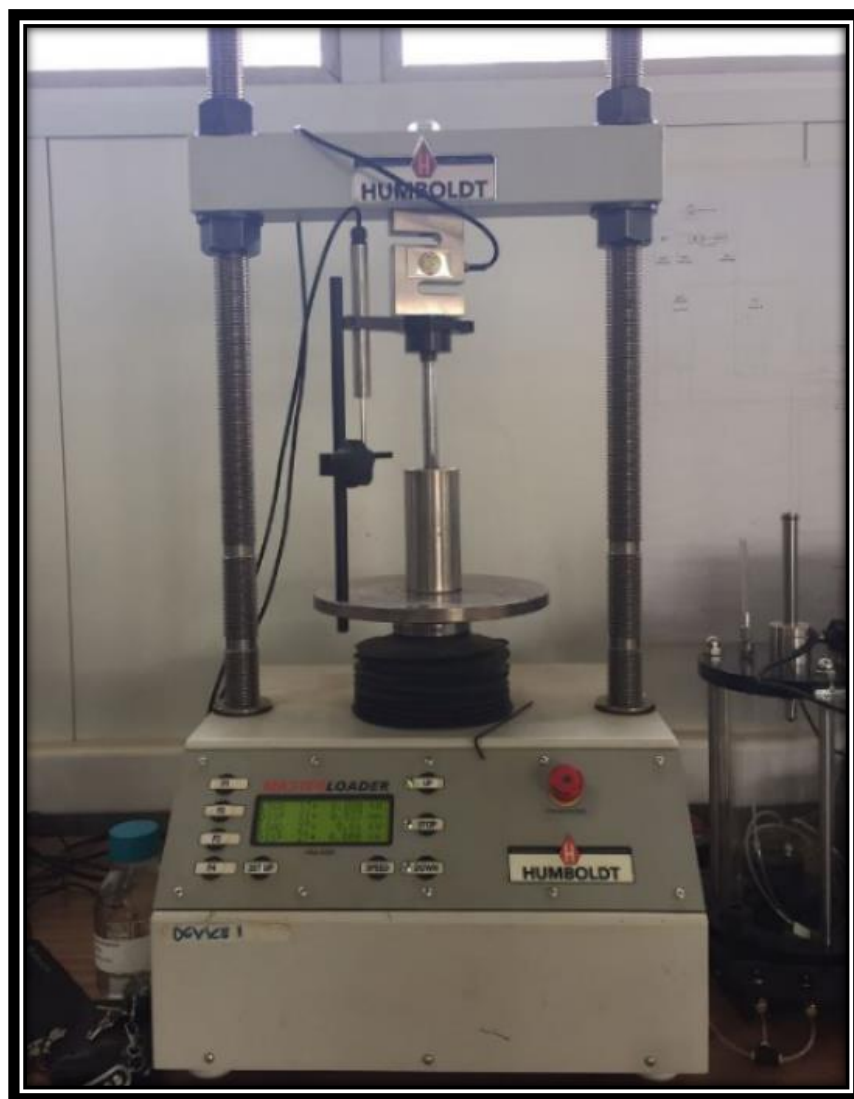
Figura 3-32: ENSAYO MINI-CBR MODIFICADO, (Fuente: propia).
