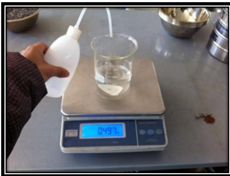
Figura 3-17: MEDICIÓN CANTIDAD DE AGUA, SEGÚN HUMEDAD ÓPTIMA, (Fuente: propia).
