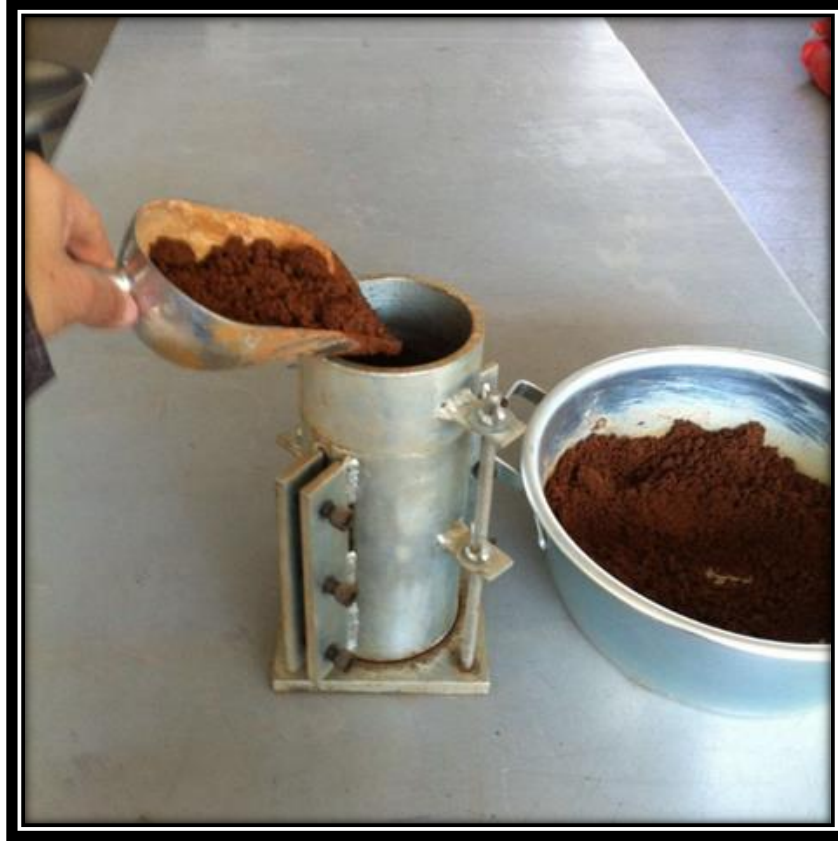
Figura 3-34: ADICIÓN DEL SUELO ESTABILIZADO AL MOLDE TRIAXIAL, (Fuente: propia).
