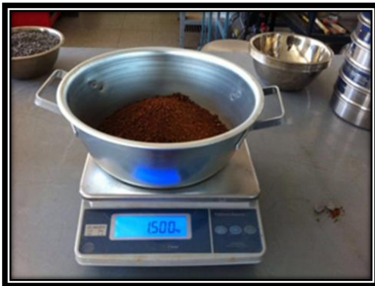
Figura 3-15: PAILA CON CANTIDAD REQUERIDA DE SUELO, (Fuente: propia).
