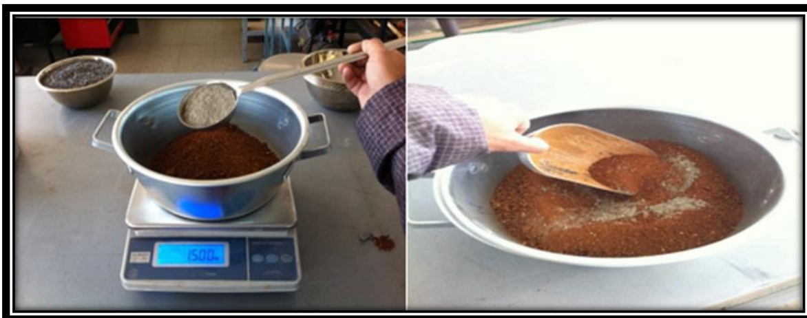
Figura 3-16: ADICIÓN DE ADITIVOS SÓLIDOS Y MEZCLADO MANUAL, (Fuente: propia).
