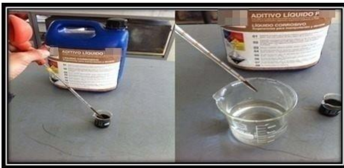
Figura 3-18: DOSIFICACIÓN ADITIVO LÍQUIDO CON PROPIPETA, (Fuente: propia).
