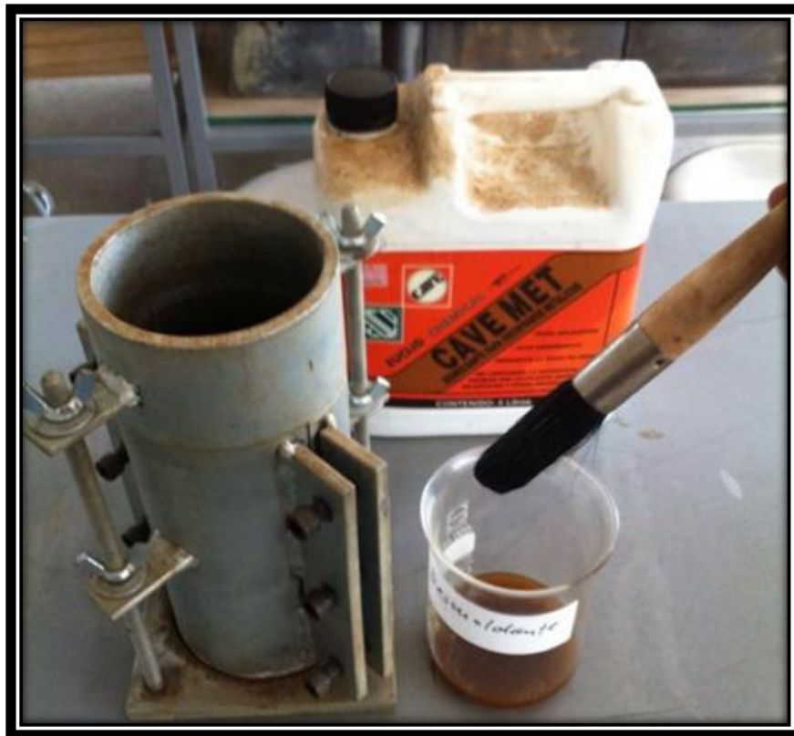
Figura 3-33: MOLDE PROBETA TRIAXIAL Y APLICACIÓN DESMOLDANTE, (Fuente: propia).
