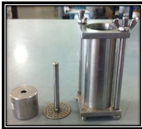
Figura 2-9: MOLDE MINI-CBR, (Fuente: propia).
