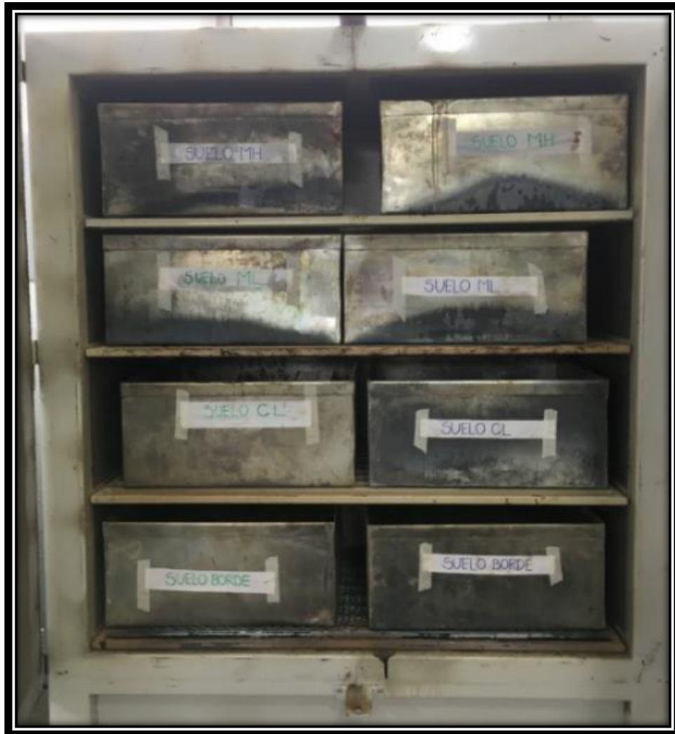
Figura 3-3: SECADO DE SUELOS EN HORNO A 110°C, (Fuente: propia).
