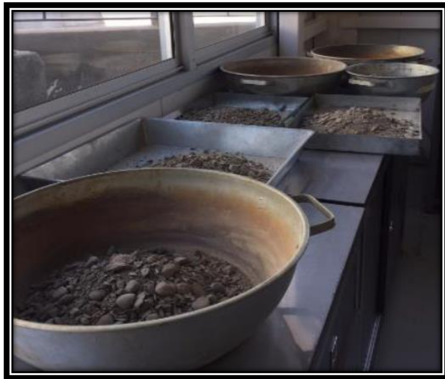
Figura 3-21: MATERIAL GRANULAR REPRESENTATIVO Y HOMOGÉNEO LUEGO DE CUARTEO, (Fuente: propia).
