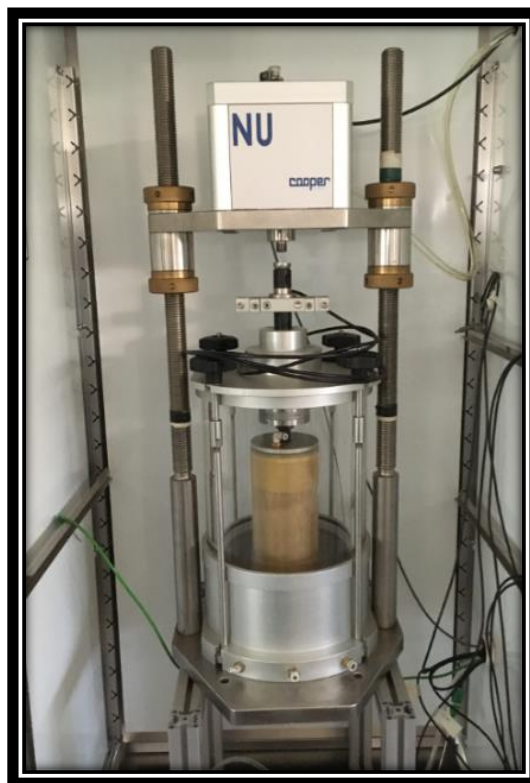
Figura 3-38: ENSAYO DE MÓDULO RESILIENTE (MrTx), EN PROBETA TRIAXIAL, (Fuente: propia).
