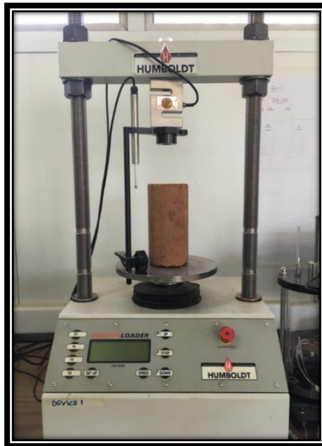
Figura 2-11: EQUIPO ENSAYO COMPRESIÓN NO CONFINADA (UCS), (Fuente: propia).
