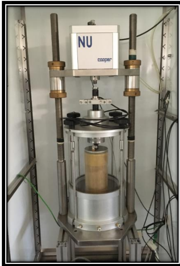
Figura 2-13: EQUIPO TRIAXIAL DINÁMICO, ENSAYO DE MÓDULO RESILIENTE (MrTx), (Fuente: propia).
