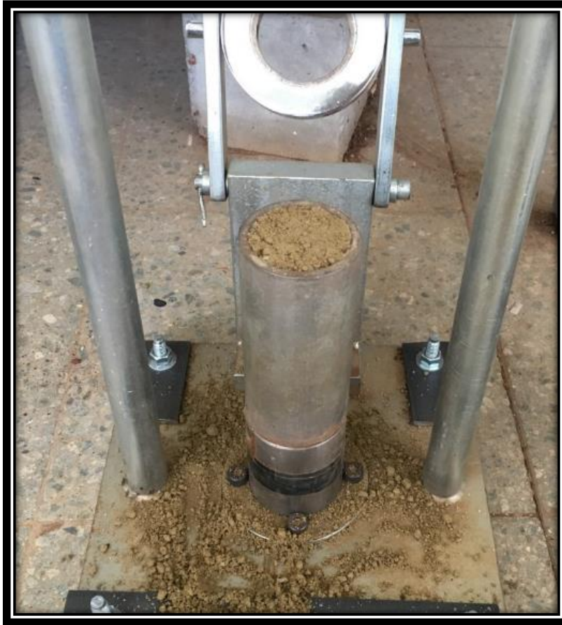
Figura 3-27: PROBETA TERMINADA CON TAMAÑO NORMALIZADO, (Fuente propia).
