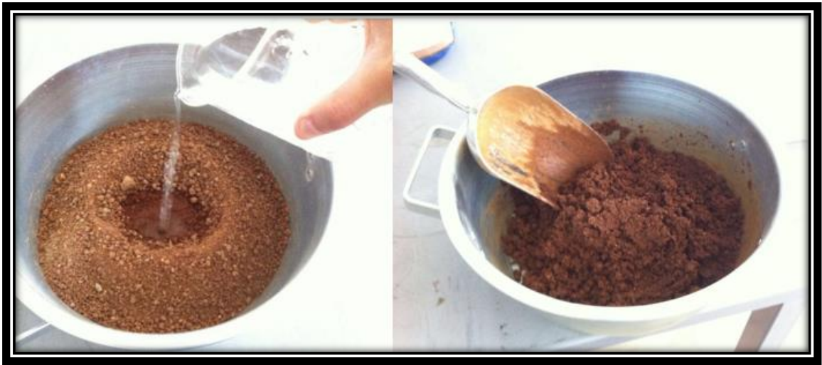
Figura 3-19: ADICIÓN SOLUCIÓN AGUA Y ADITIVO LÍQUIDO EN SUELO SECO, (Fuente: propia).
