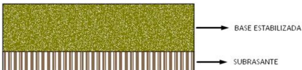
Figura 2-1: ESTRUCTURA DE CAMINO NO PAVIMENTADO, (Fuente: propia).
