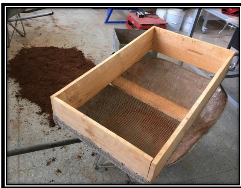
Figura 3-5: TAMIZADO DEL SUELO EN HARNERO MALLA N°4, (Fuente: propia).
