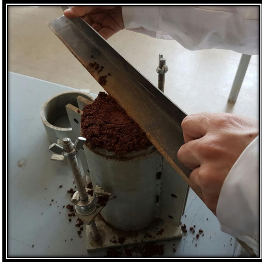
Figura 3-36: RASADO PROBETA TRIAXIAL, (Fuente: propia).
