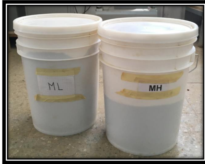
Figura 3-6: TAMBORES SELLADOS CON SUELO HOMOGENIZADO SECO, (Fuente: propia).
