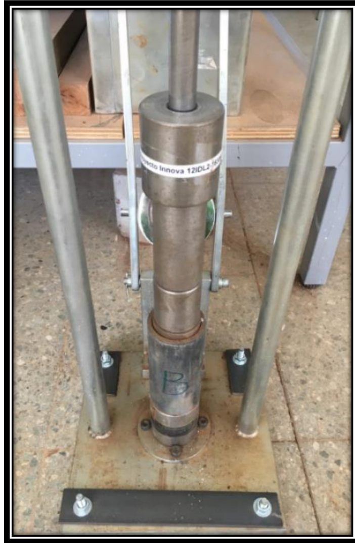
Figura 3-25: PISÓN LISTO PARA COMPACTACIÓN, (Fuente: propia).
