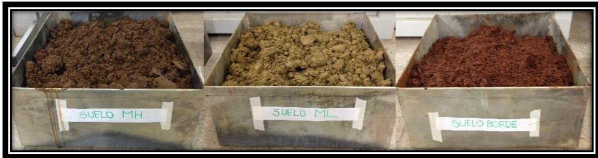
Figura 3-1: SUELOS EN CONDICIONES NATURALES DE TERRENO, (Fuente: propia).
