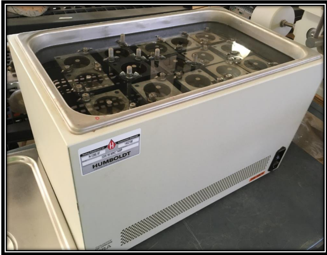
Figura 3-31: PROBETAS SUMERGIDAS, (Fuente: propia).
