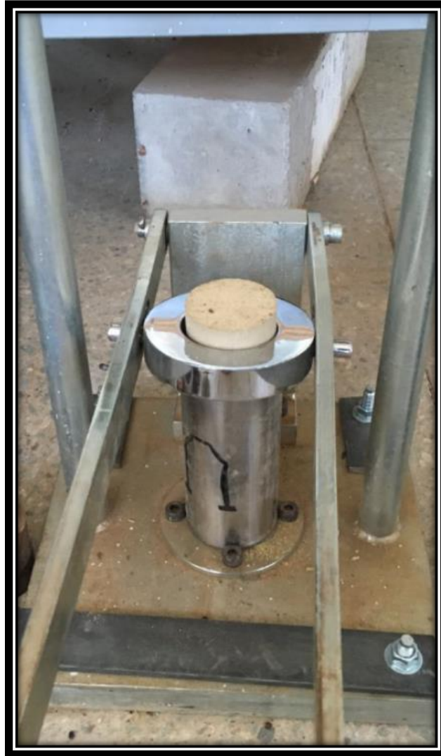
Figura 3-26: EXTRACCIÓN EXCEDENTE DEL SUELO COMPACTADO, (Fuente: propia).
