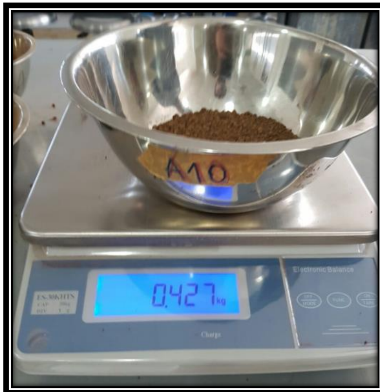
Figura 3-23: MUESTRA DE SUELO SECADA EN HORNO, (Fuente: propia).
