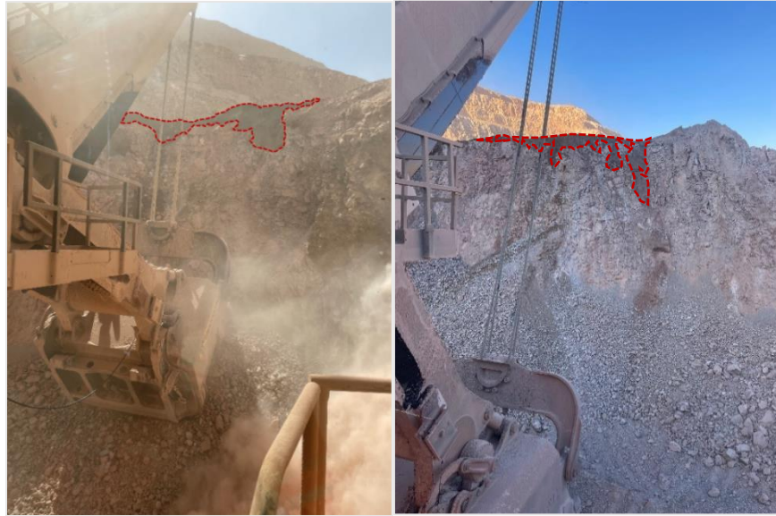
Figura 3.7: Percolación incompleta del supresor de polvo.
