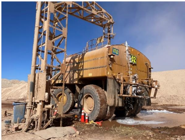
Figura 3.13: Desperdicio de producto por rebose.
