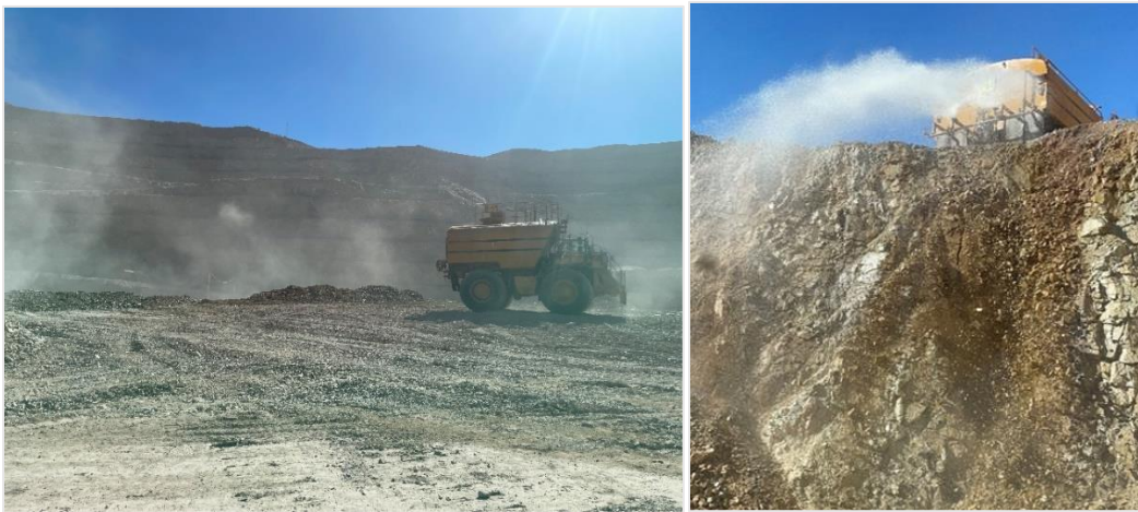
Figura 3.8: Producto aplicado directamente en la frente.
