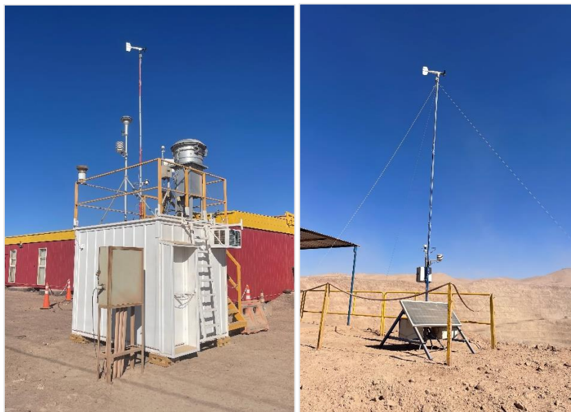
Figura 2.17: Estación de monitoreo MP10 campamento y Fase 4.
