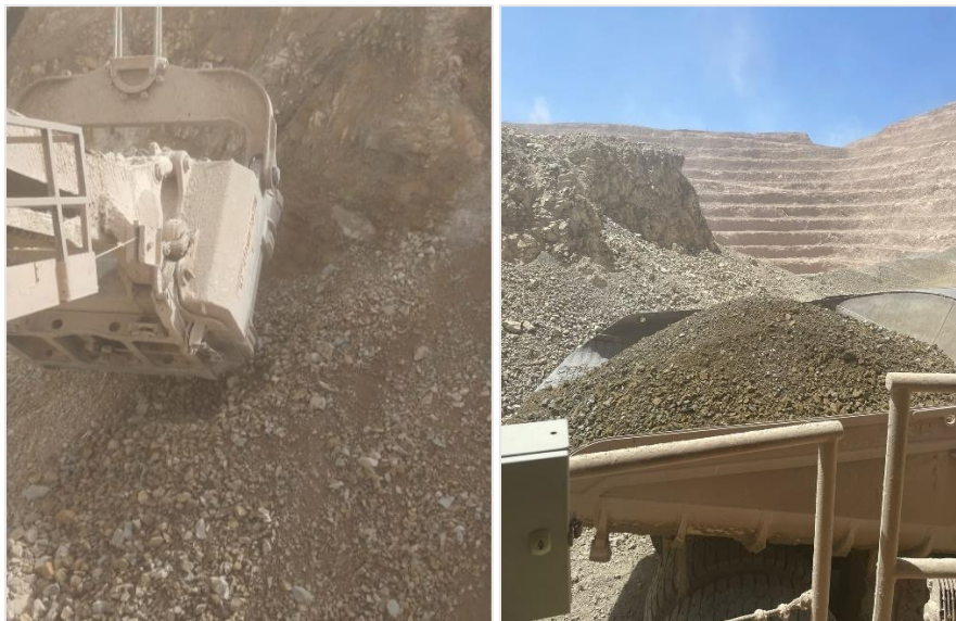
Figura 4.13: Extracción y llenado del caex con material humectado.
