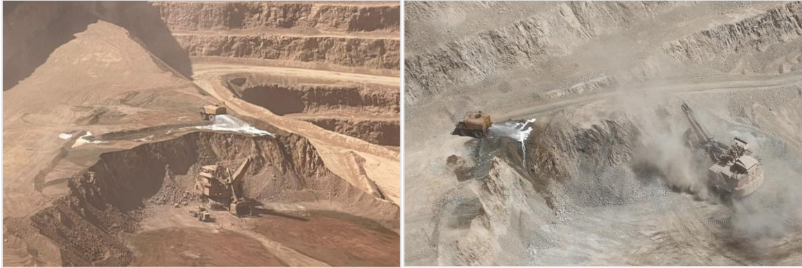
Figura 3.2: Aplicación de surfactante llevada a cabo en la actualidad.
