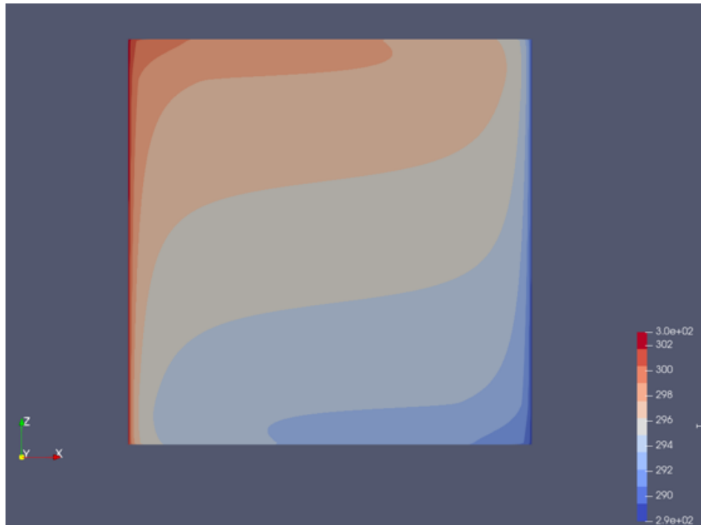
Figura 3.5: Discretización del perfil de temperatura en una pared vertical pasiva para el caso #4 utilizando la ecuación 3.11 extraída de la investigación de Sargent [15].
