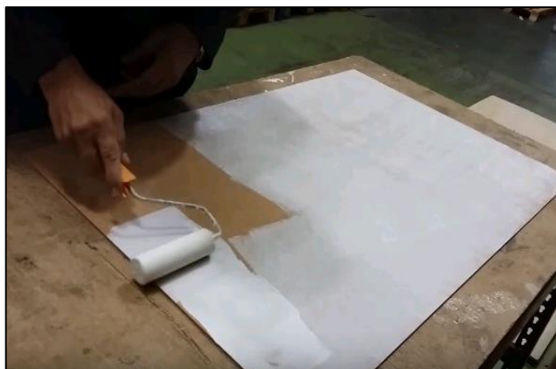
Colocación de adhesivo de contacto en placas de corcho aglomerado [1-8] (Fuente: Barnacork)
