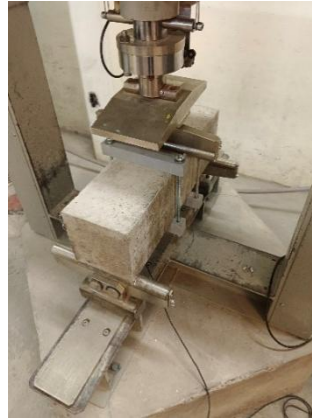
Figura 13: ensayo Pre-cracking realizado en laboratorio.
