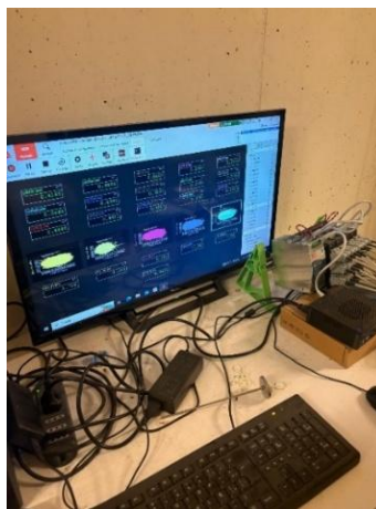
Figura 23: sistema de adquisición de datos Creep en LEMCO.
