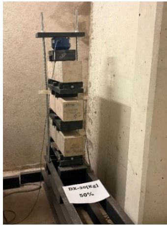
Figura 22: probetas Dramix con 50% montadas en marcos según RILEM 2021.
