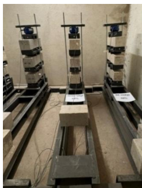
Figura 7: montaje de probetas para Creep con configuración 4PBT en LEMCO.
