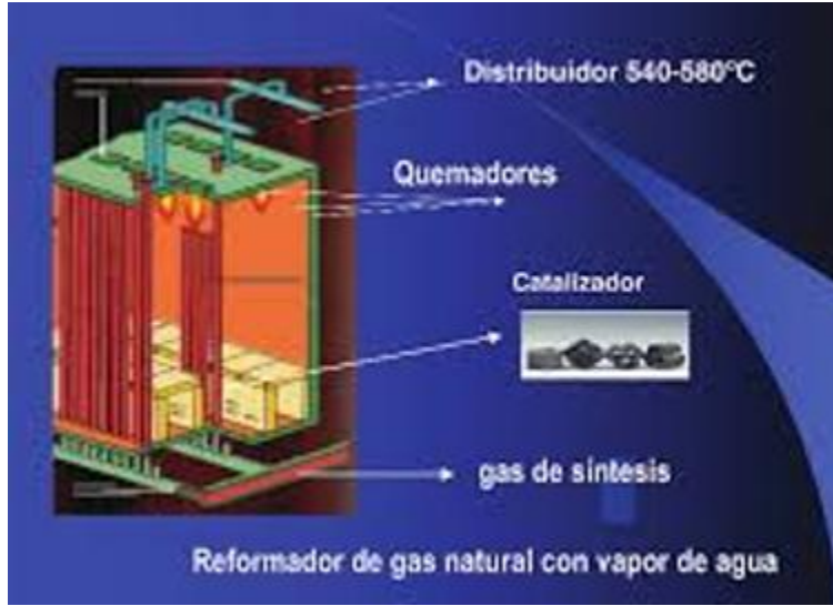
figura 6 "esquema de un reactor de reformado por vapor"
