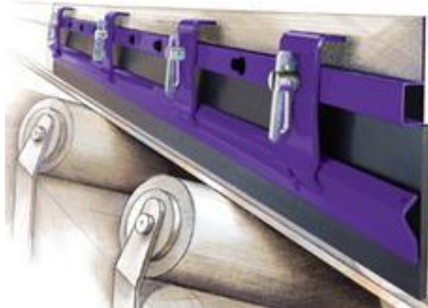
Ilustración 17: Guardera que evita el escape de material por los costados, en que la dureza de la guardera es menor que de la cinta.
