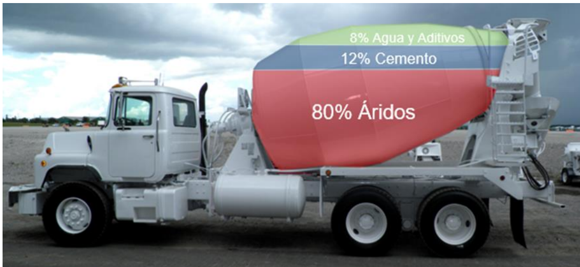
Ilustración 6: Valor porcentual de agua cemento y áridos necesarios para formar el hormigón
