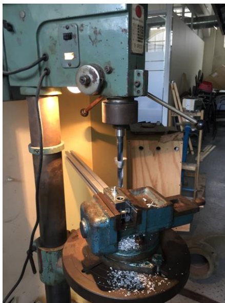
Figura 39 Corte de perfil montado taladro de pedestal
