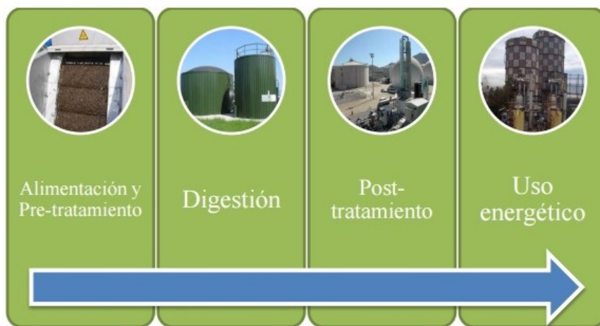
Figura 4.23: Esquema de las etapas que se realizan en la producción de biogás. (Fuente: (Carrasco, 2015))
