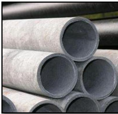
Ilustración 2-4, Tubería de asbesto cemento.
