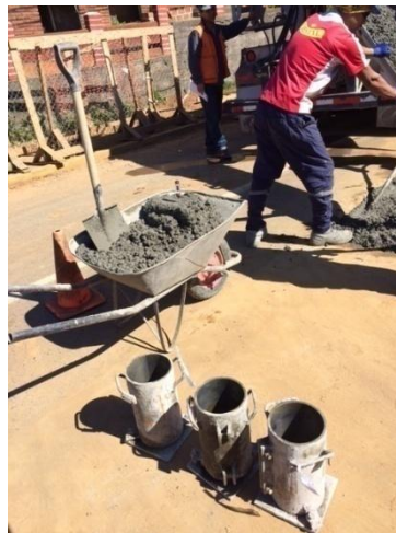
Ilustración 4-26, Probetas para muestras de hormigón in situ.
