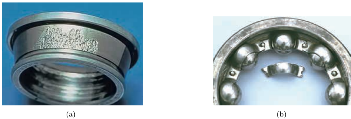
Figura 2.2. Ejemplos de consecuencias de mecanismos de degradación en elementos de un sistema de rodamientos [24]. Entre ellos, (a) escamado en pista interna y (b) fractura por fatiga mecánica en jaula.
