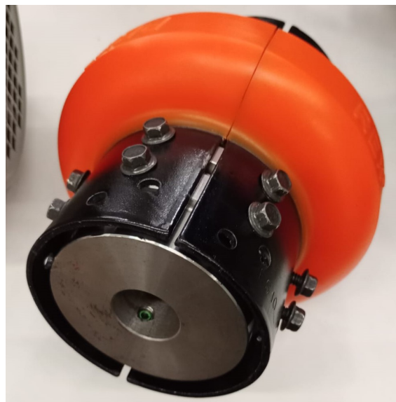
Figura 5.2. Acople flexible Rexnord Omega modelo ES10-R utilizado en el banco de pruebas para la conexión motor-generador.
