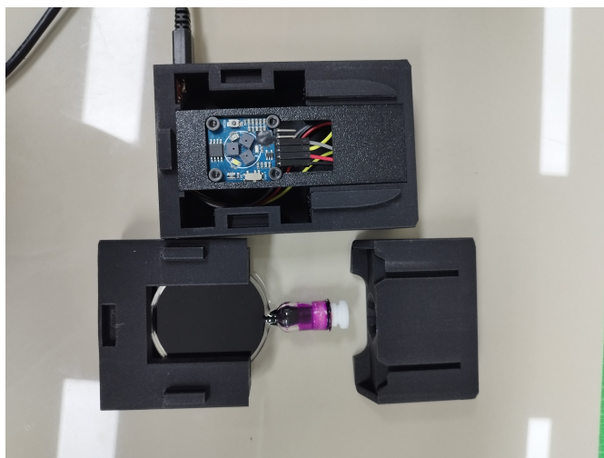
Figura 4.1: Prototipo actual de espectrómetro móvil.
