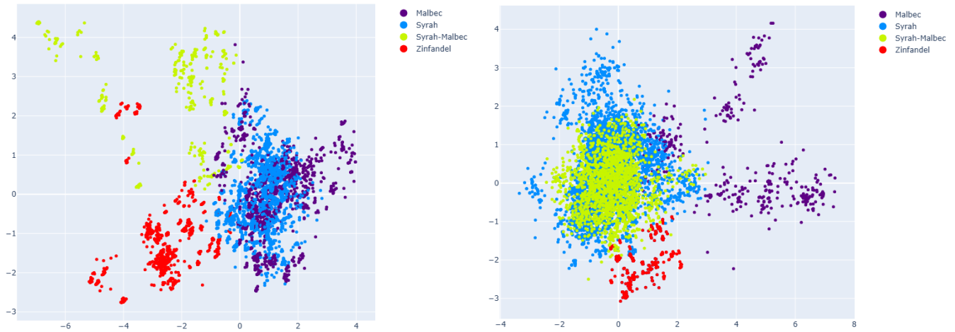
Figura 5.17: Comparación entre la distribución original sin ruido (izquierda) y la distribución resultante tras la inyección de ruido gaussiano (derecha), proyectadas mediante LDA para las cepas Malbec, Syrah, Syrah-Malbec y Zinfandel.
