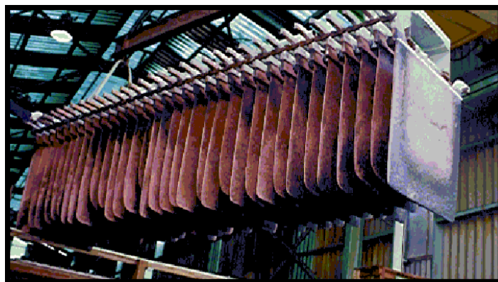
Figura 2.8 Scrap anódico de electrorefinación.
