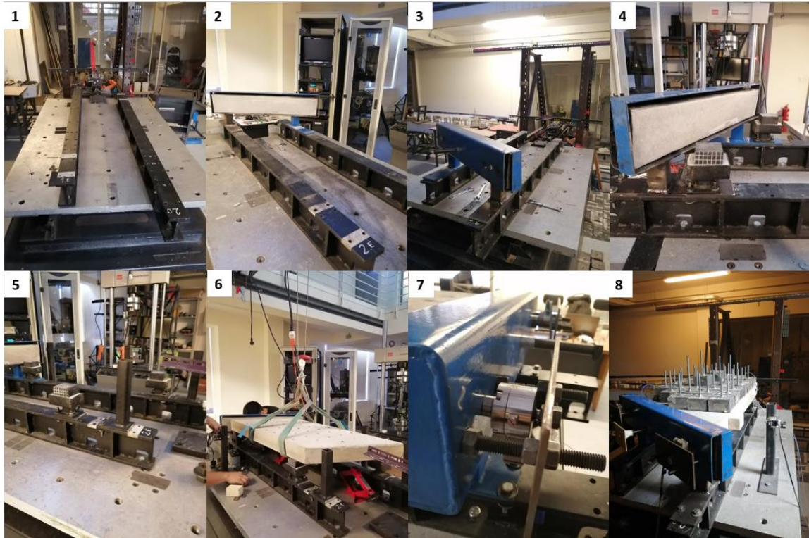
Figura 16: Compilación de imágenes para el montaje del puente esviado 30°. Fuente: Arredondo (2023)
