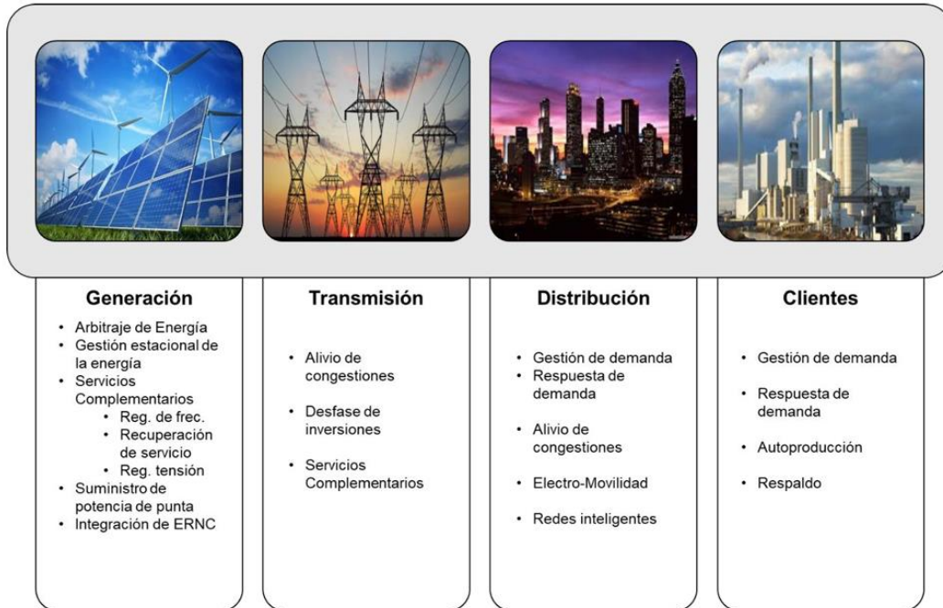
Figura 30: Resumen de aplicaciones BESS en sistemas eléctricos. [3]
