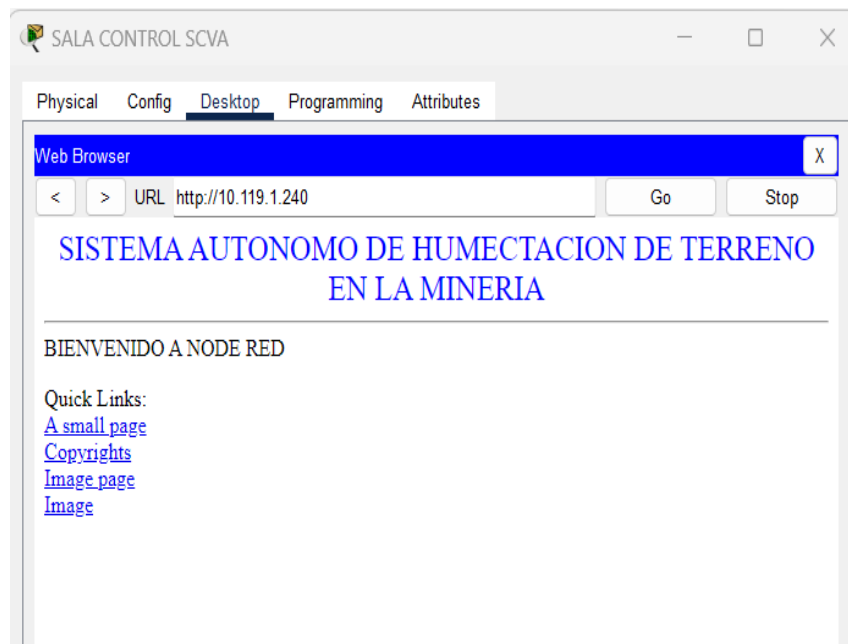
Figura 2-16.- Prueba de comunicación desde computador de sala de control red SCVA a Raspberry PI mediante servidor WEB Node-RED
