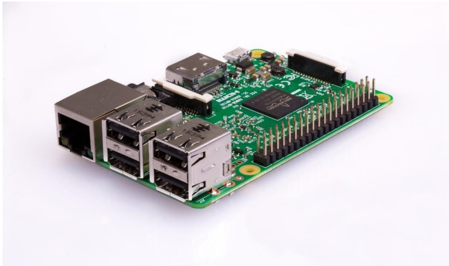
Figura 2-2.- Tarjeta de desarrollo Raspberry PI 3
