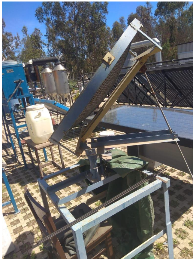
Figura 2-3: Concentrador solar y su estructura. Fuente: elaboración propia.
