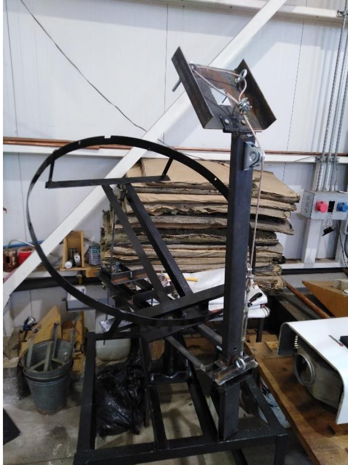
Figura 3-1: Imagen de brazo que soporta el reactor montado en el soporte del concentrador.
