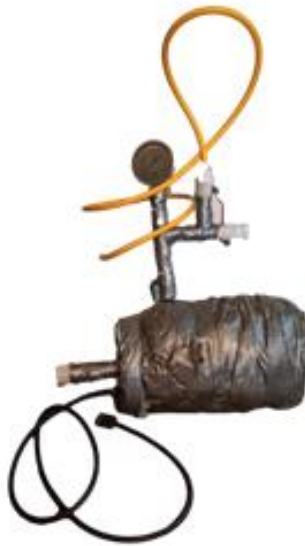
Figura 2-6: Generador de vapor. Fuente: elaboración propia.
