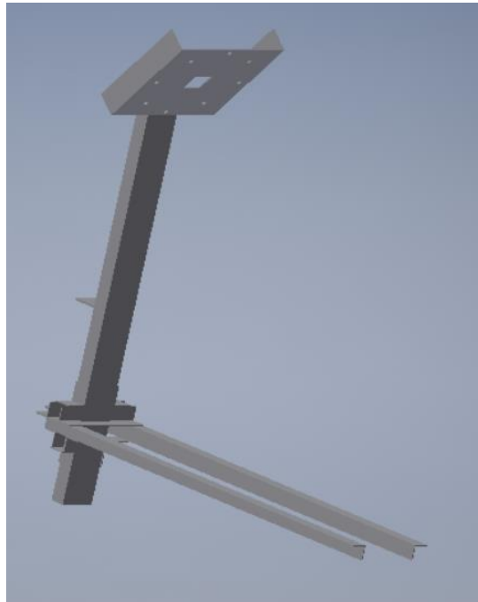
Figura 3-2: Imagen del diseño del soporte del reactor. Fuente: elaboración propia.
