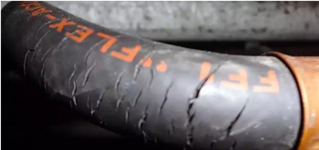
Figura 20: Desgaste en el Flexible Hidráulico. Fuente: https://kingdaflex.com/es/how-to-replace-a-hydraulic-hose/
