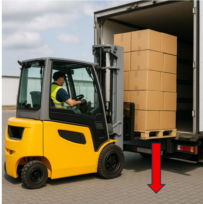
Figura 17: Mala Operación de la Grúa Horquilla
