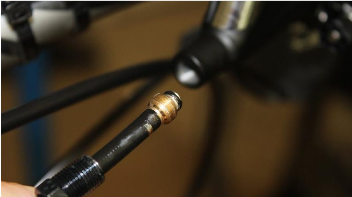
Figura 19: Desgaste cerca de la conexión del Flexible. Fuente: https://kingdaflex.com/es/how-to-replace-a-hydraulic-hose/
