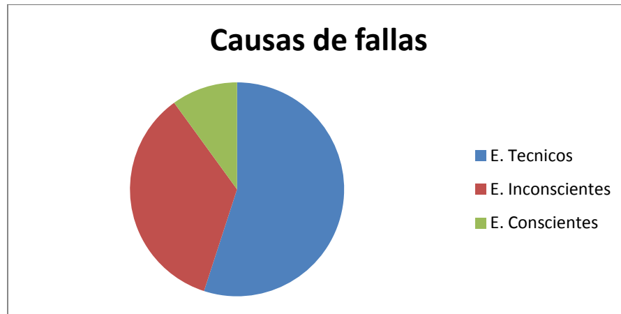
Ilustración 4: Distribución normal de causas de fallas humanas. (1)
