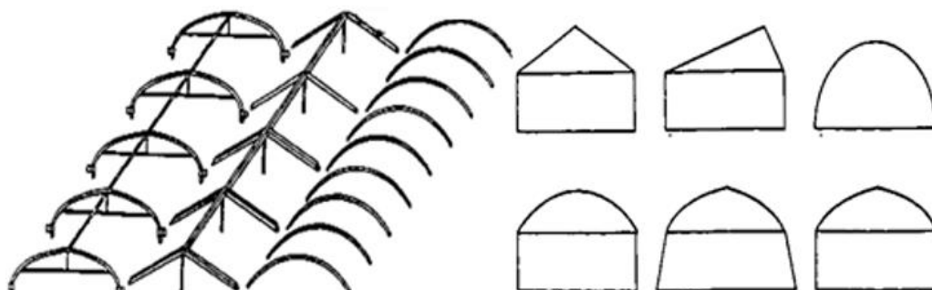
Ilustración 2-10 Tipos de techos y cubiertas para invernaderos
