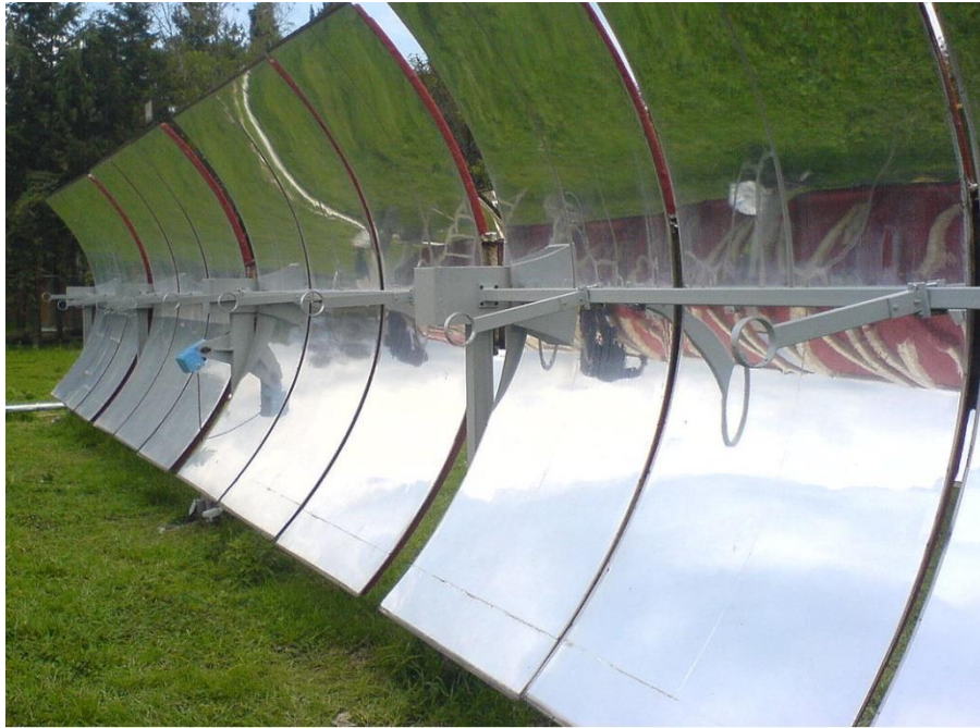
Ilustración 2-5 Colector parabólico compuesto
