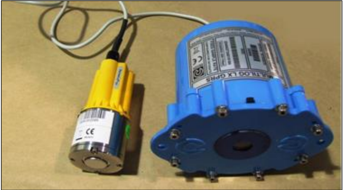
Figura 2: Equipo Multilog LX GPRS y permalog plus (+). Fuente: Empresa DNK Water SpA.
