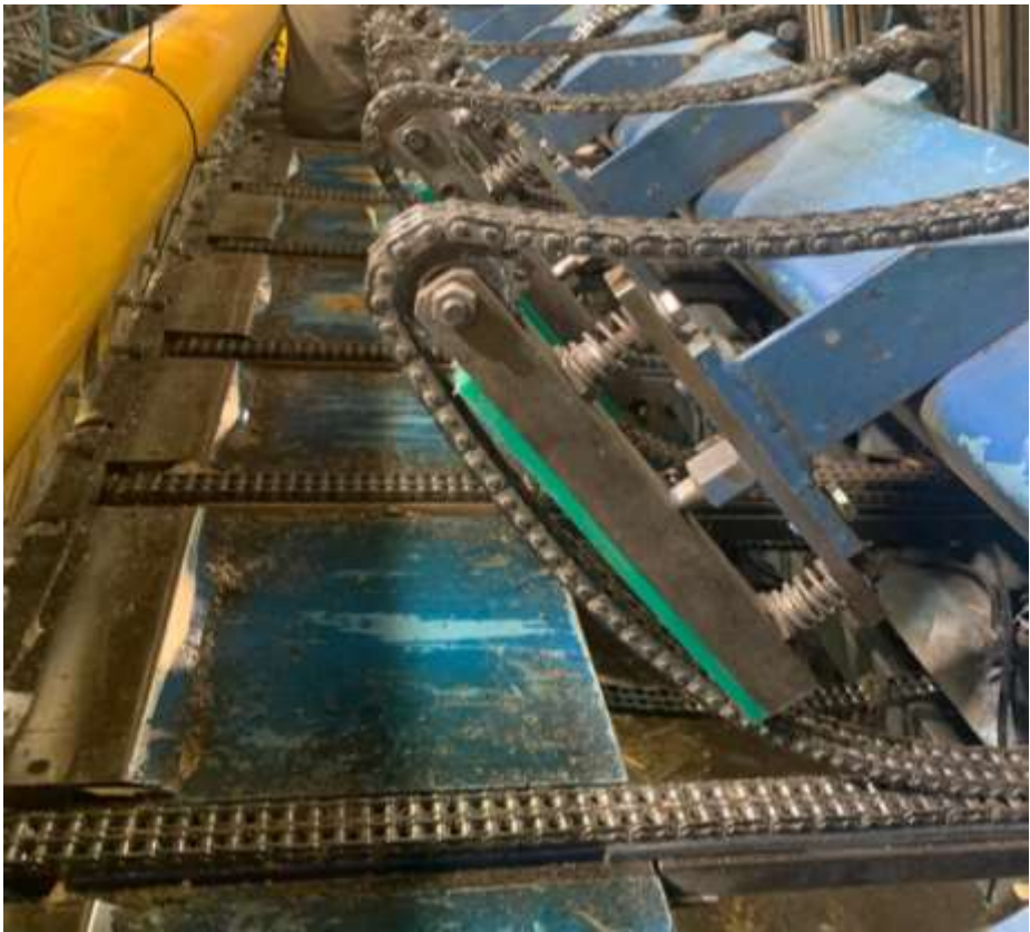
Figura 13.- Conjunto transmisión cadenas unidad de ensamblado.
