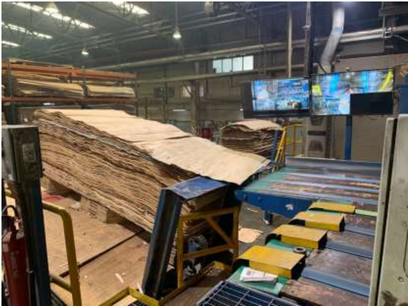
Figura 10.-Mesa alimentación de almacenaje de chapas.
