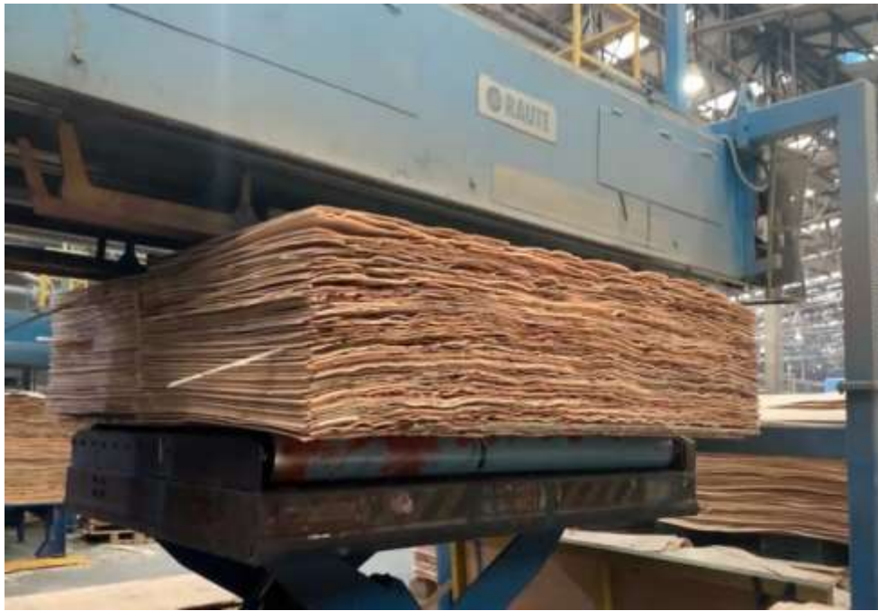
Figura 8.- Transportador de salida de chapas.
