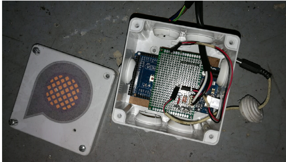
Figura 28: Control de velocidad del ventilador.
