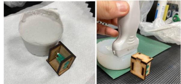
Figura 18 - Muestras de Silicona y Método de Medición en Ultrasonido con Agujas.
