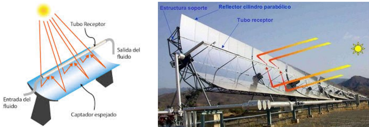
Figura 1.7: Colectores Cilindro Parabólicos
