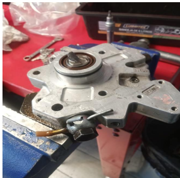
Figura 33- bomba rotativa con eje cortado
