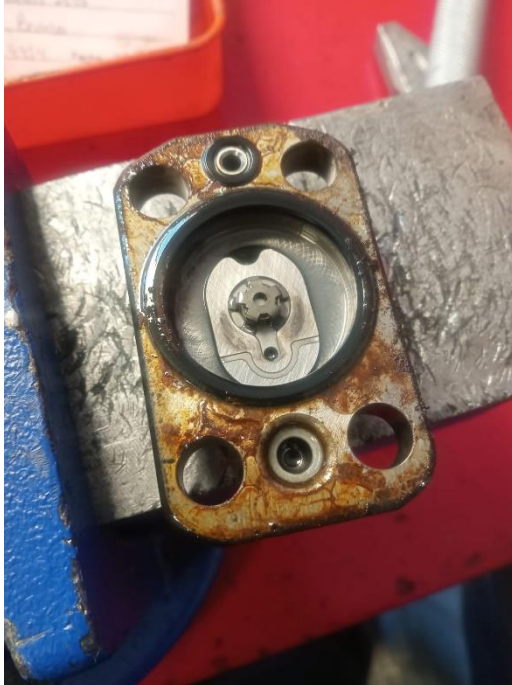
Figura 34- culatín contaminado y con oxido
