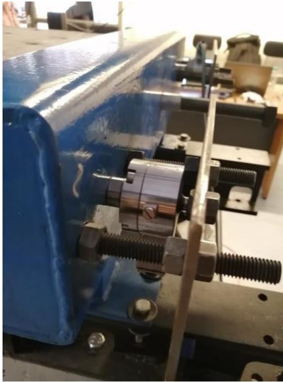
Figura 22: Conexión celda de carga
