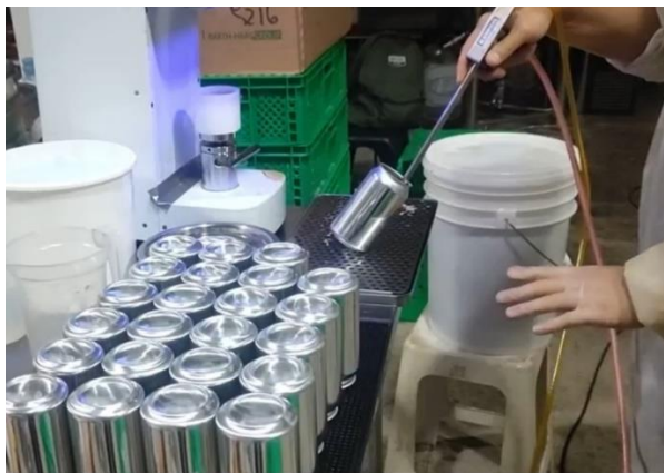
Imagen 1-7. Foto referencial del proceso llenador de la lata de cerveza. Fuente: Cervecería San Rafael Ltda.
