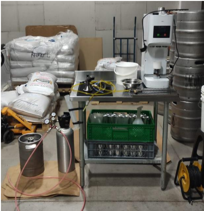
Imagen 1-6. Foto referencia sistema actual de llenado. Fuente: Cervecería San Rafael Ltda.
