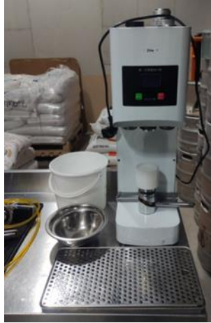
Imagen 1-4. Selladora de latas semiautomática. Fuente: Cervecería San Rafael Ltda.
