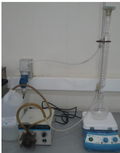
Fuente: captura propia en base a la instalación del sistema de la funcionalización de micro burbujas
