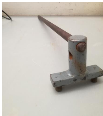
Figura 3-2: Llave de ajuste especial para regular la abertura de descarga del chancador de mandíbulas.
