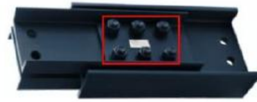
Ilustración 4. Disipador friccional. El recuadro rojo señala los pernos utilizados para variar la fuerza de activación del dispositivo.
