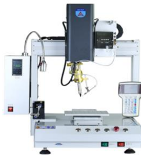
Figura 99. Soldadora CNC Dongguan Biaoganzhizao Equipment Co., Ltd. Modelo: BG-55441
