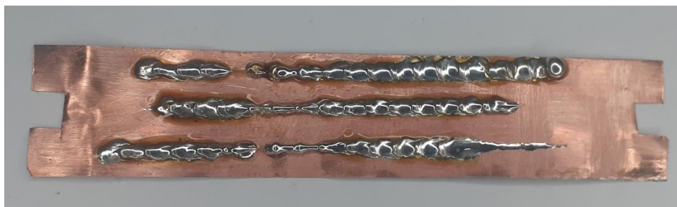
Figura 133. Resultado de los cordones de soldadura obtenidos realizando movimientos de vaivén.
