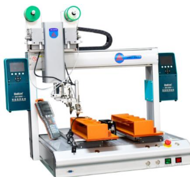
Figura 101. Soldadora CNC Shenzhen Juli Brothers Machinery Co., Ltd. Modelo: JL-H331R
