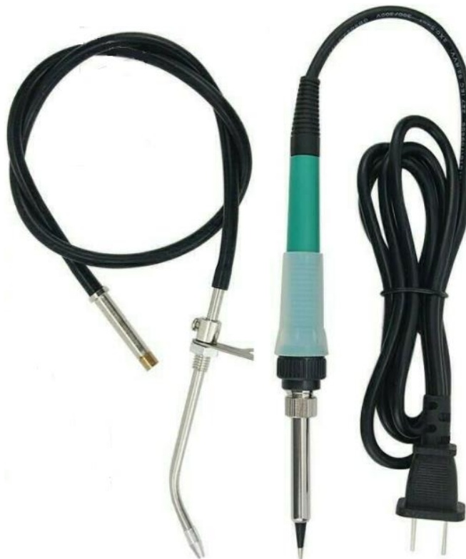
Figura 70. Cabezal soldador de la estación de trabajo de soldadura S3100 y que se utilizara en este proyecto.
