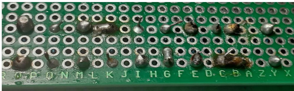
Figura 126. Resultados de prueba de soldadura en resistencias separadas por 5,08 [mm].
