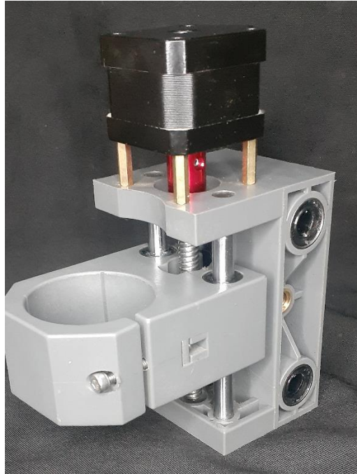
Figura 116. Estructura de apoyo y carro Z con su sistema de posicionamiento y motor paso a paso.
