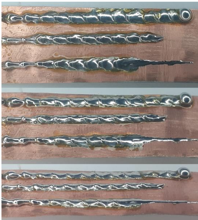
Figura 134. Resultados más aceptables del proceso de soldadura realizando cordones con movimiento de vaivén.
