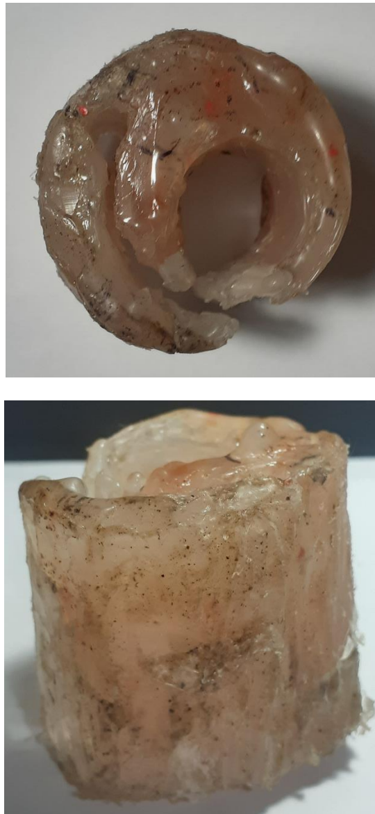
Figura 118. Abrazadera hecha manualmente utilizada para acoplar el cabezal soldador al carro Z.
