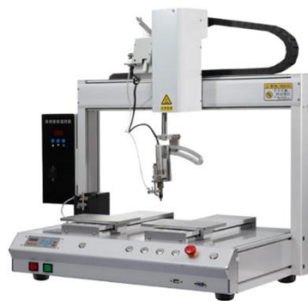
Figura 100. Soldadora CNC Guangdong Xiaowei Intelligent Technology Co., Ltd. Modelo: XW-SS331R
