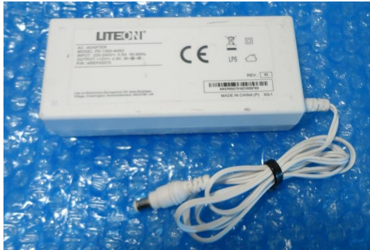
Figura 73. Transformador Liteon pe1300 de 12 [V] utilizado en este proyecto.
