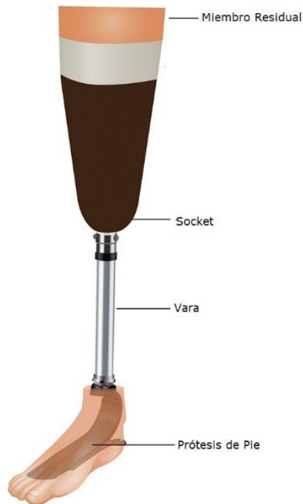
Figura N° 3.23: Estructura general de una prótesis transtibial
