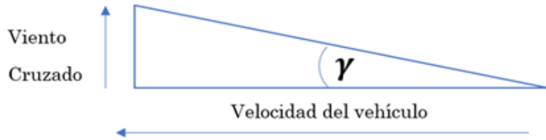
Ilustración 23. Vectores de velocidad axial y transversal del vehículo en movimiento.
