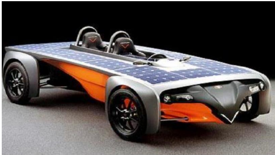
Imagen 15. Venturi Astrolab, un vehículo solar comercial capaz de llegar a los 120 [km/h].
