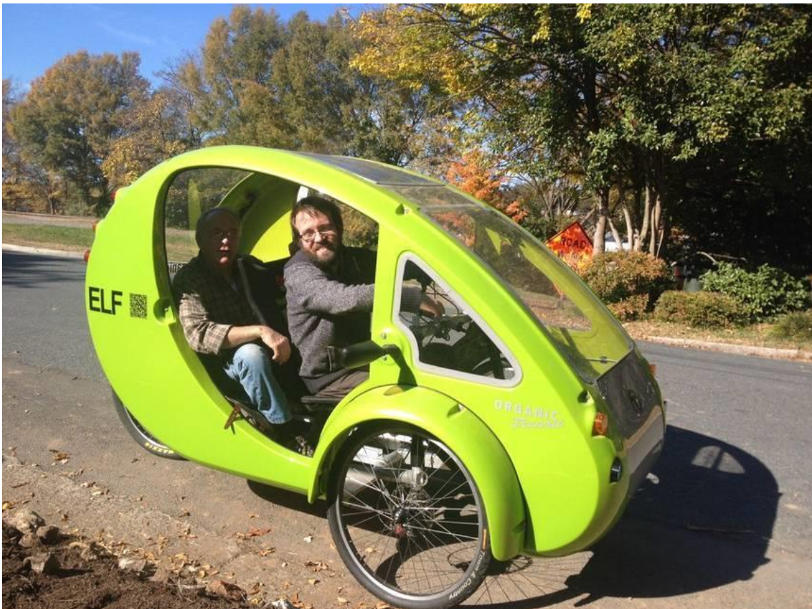
Imagen 18. ELF. Desarrollado por Organic Transit, empresa estadounidense. Monta baterías y un panel fotovoltaico en su techo. Fuente: https://electrek.co .
