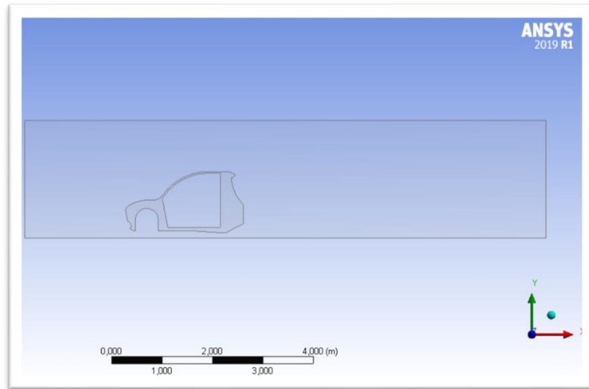
Imagen 30. Vista lateral del volumen de control que envuelve a la geometría del vehículo.
