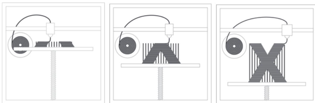
Ilustración 1-16. Representación proceso impresión FFF
