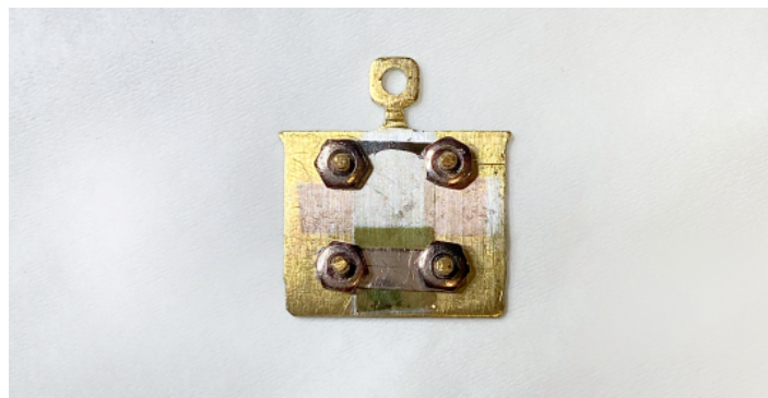
Figura 6.3: Fotografía de portamuestras listo para fabricación de película de cobre.
