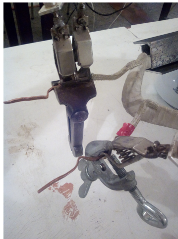
Figura 4.6: Montaje de conectores alternativos con prensa auxiliar.
