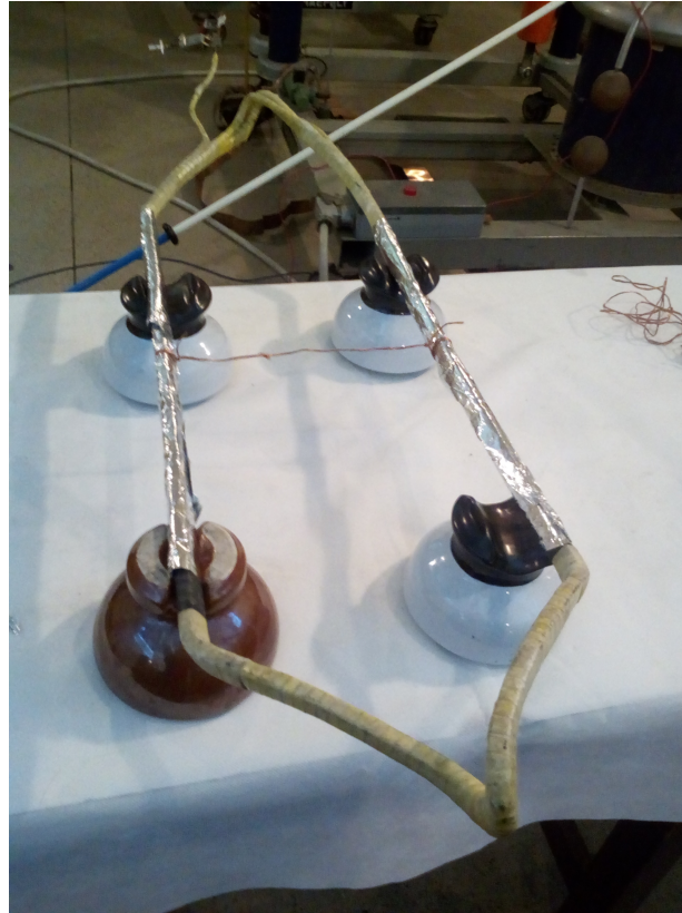
Figura 6.3: Montaje bobina con papel aluminio
