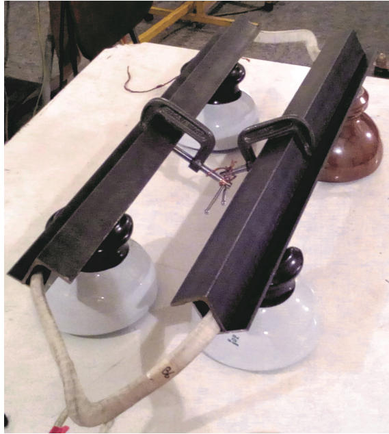
Figura 6.4: Montaje bobina con perfiles de hierro
