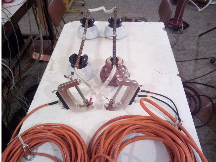
Figura 4.3: Montaje de probetas en el laboratorio
