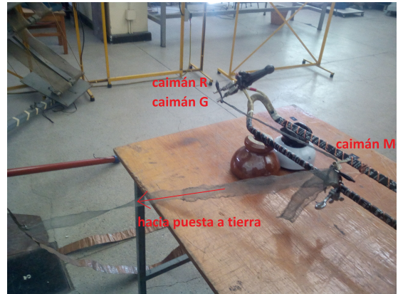
Figura 4.8: Conexión de pantallas a tierra para ensayo GR12 Mt.
