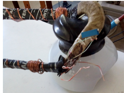
Figura 6.11: Ejemplo de cortocircuito con resistencia de 4.5\Omega .
