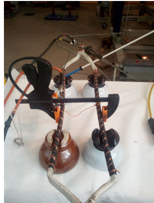
Figura 6.28: Bobina sometida a flexión interior.
