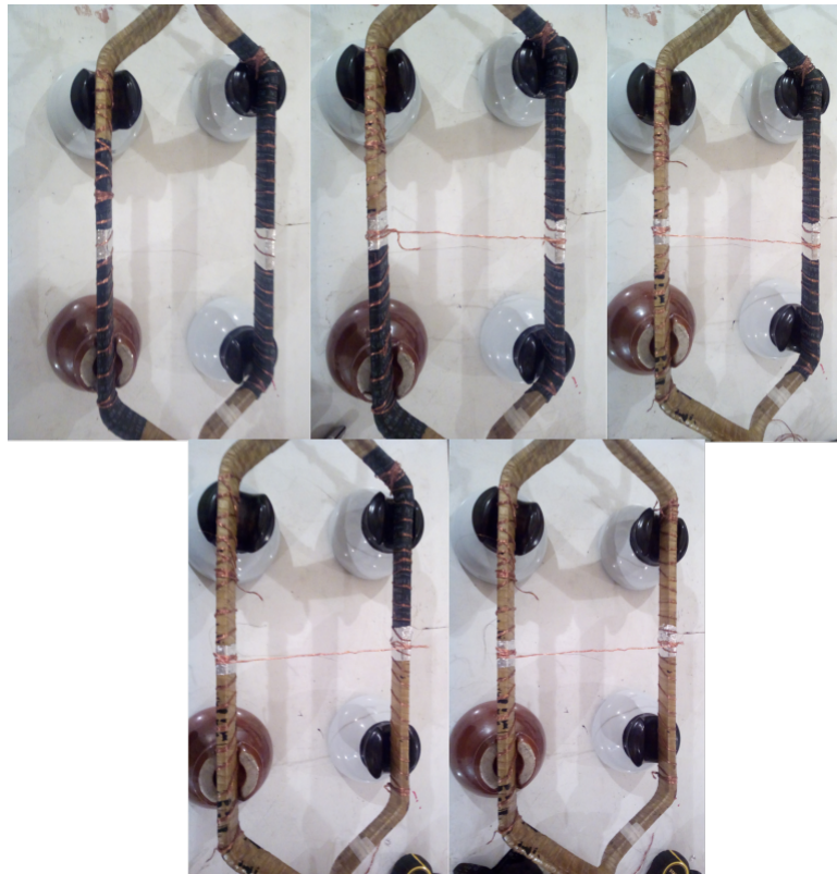
Figura 6.19: Perdida de cinta semi-conductora - Etapas del ensayo
