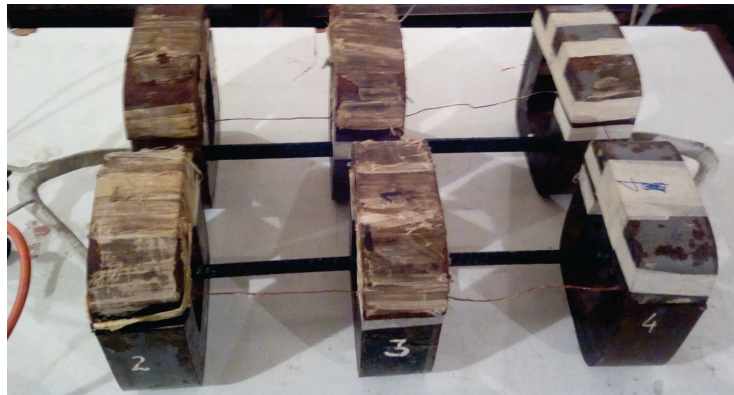
Figura 6.5: Montaje de bobina con en núcleo de hierro laminado
