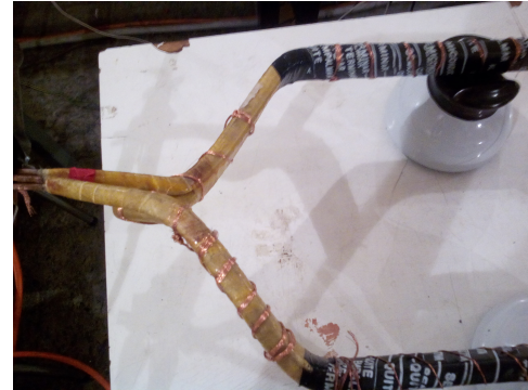
Figura 6.15: Emulación de contaminación superficial terminales.
