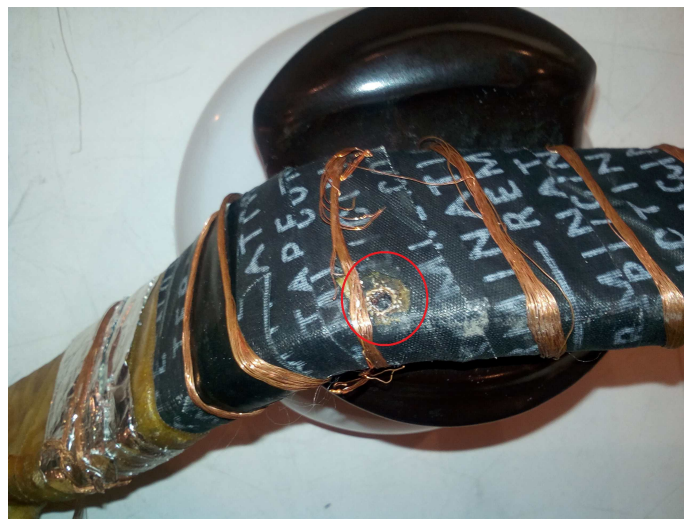
Figura 4.30: Bobina 2 - falla preexistente
