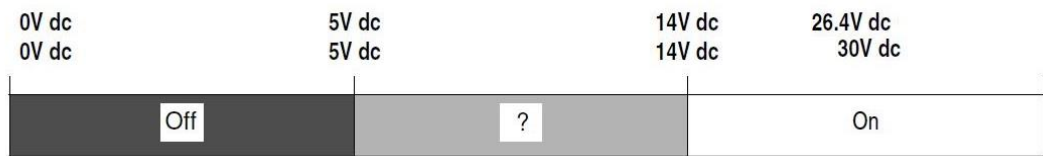
Figura 3-5. Rango de operación para una entrada del PLC.
