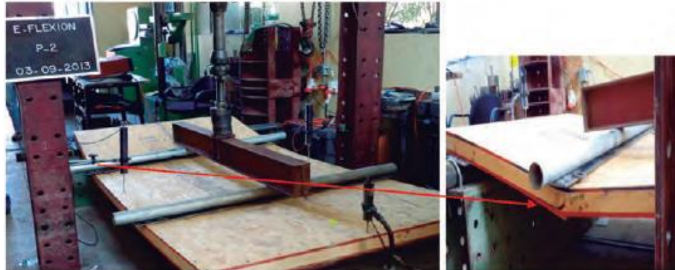
Figura 4.1.2.3.2 Falla del ensayo de flexión.
