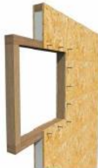
Figura 4.3.2.6. Instalación de vanos.
