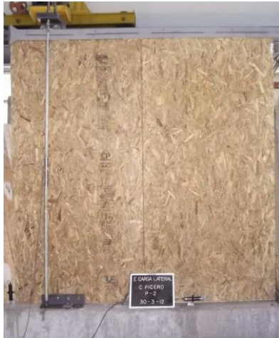
Figura 4.1.2.2.1. Montaje ensayo de carga horizontal cíclica.
