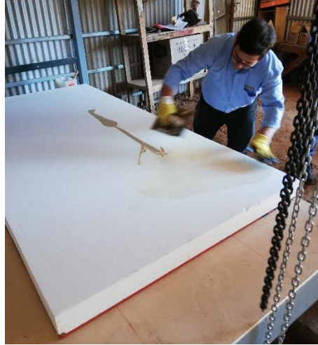
Figura 5.3.3.2. Aplicación del adhesivo.
