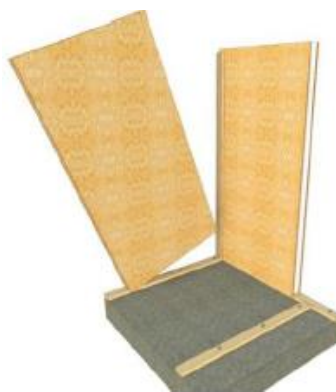
Figura 4.3.2.2. Instalación paneles SIP
