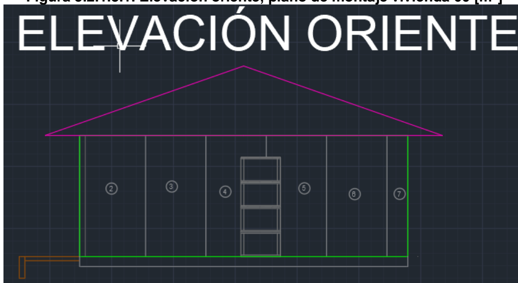
Figura 5.2.1.3.1. Elevación oriente, plano de montaje vivienda 60 [m 2 ]
