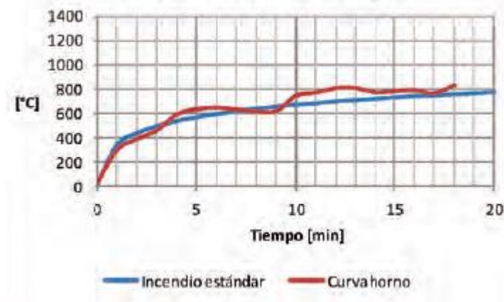
Gráfico 4.1.3.2. Curva horno de ensayos. (Extraído del Manual 5, del estudio mencionado en el punto 4.1).
